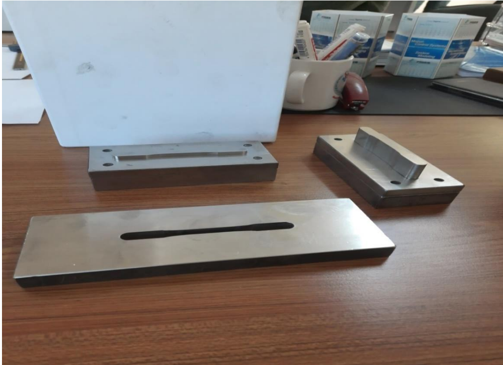
Şekil 3.7. Çekme numune üretiminde kullanılan çelik kalıp
