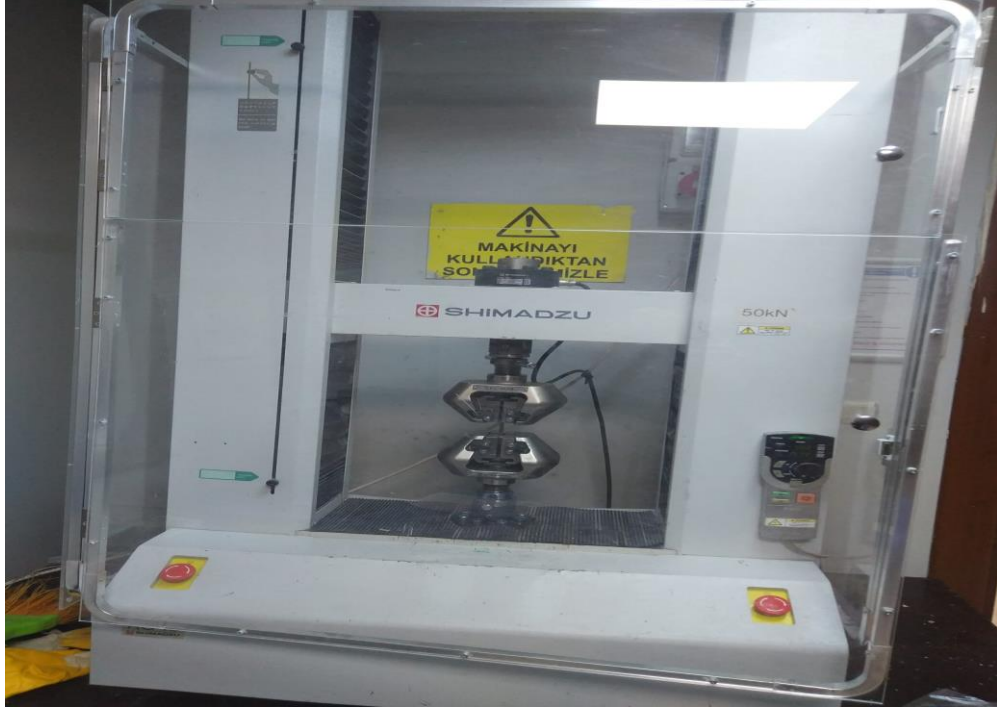
Şekil 3.16. Çekme testinin yapıldığı cihaz
