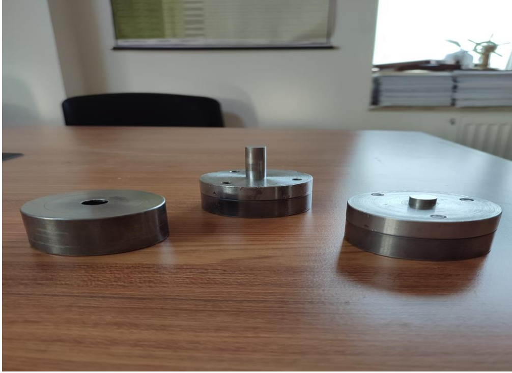
Şekil 3.6. Silindirik numune üretiminde kullanılan çelik kalıp
