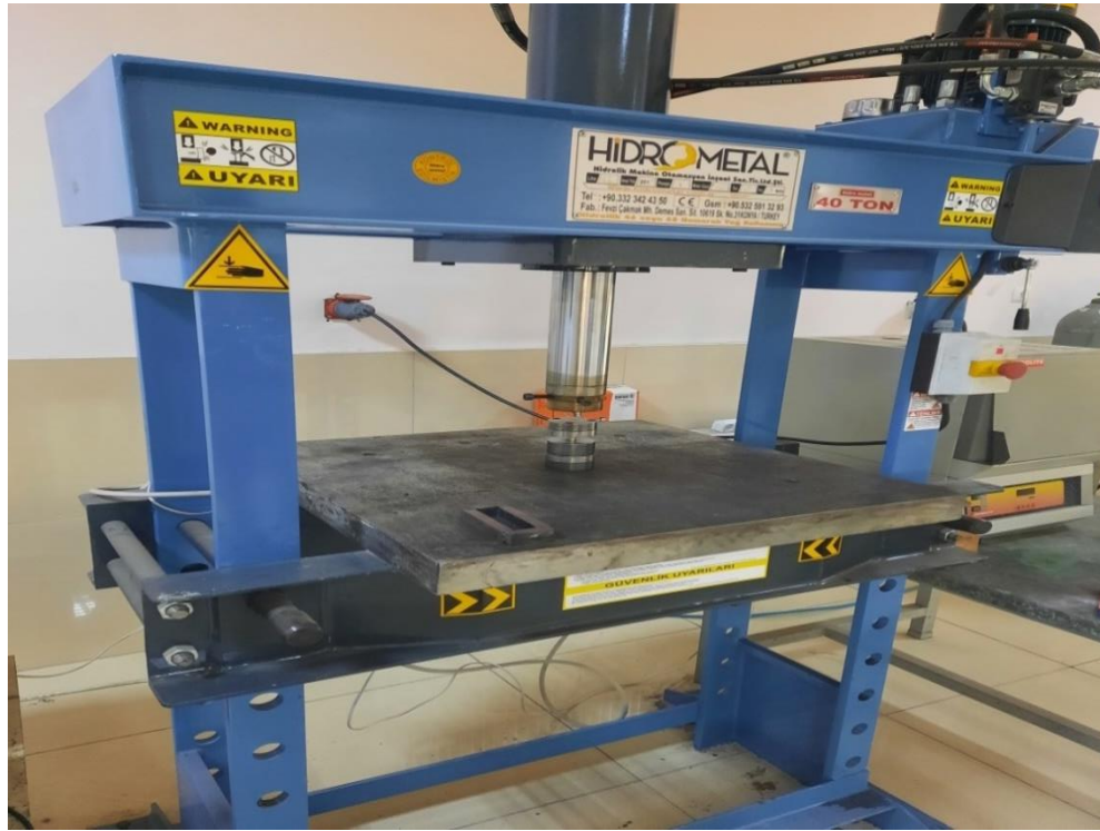
Şekil 3.5. Soğuk presleme işleminin yapıldığı hidrolik ünite
