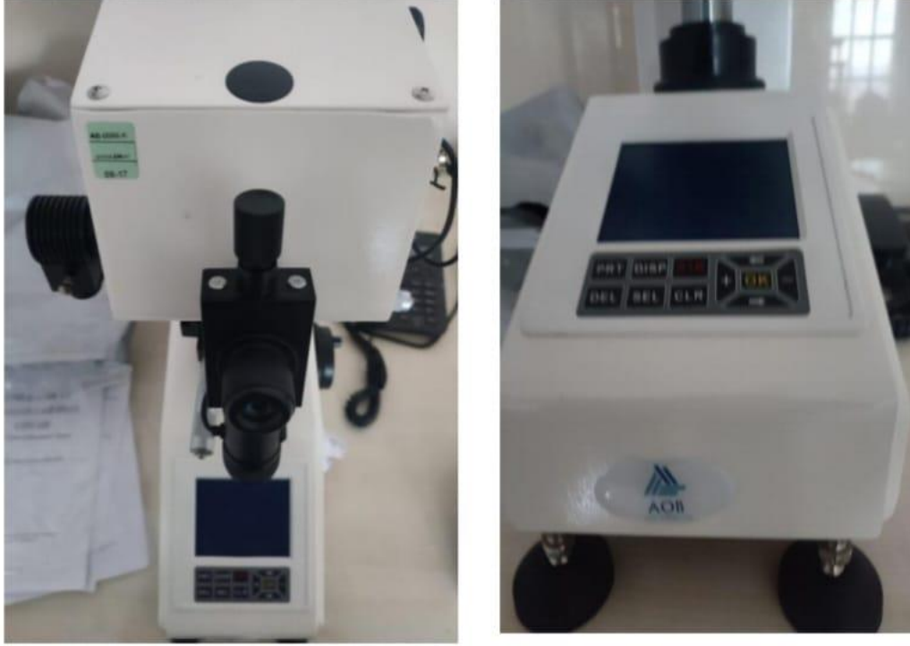
Şekil 3.14. Vickers sertlik ölçüm cihazı
