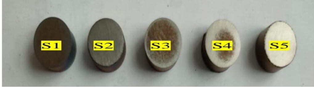
Şekil 3.11. Sinterlenen silindirik numune görselleri; S1=Ti4Mo5Cu, S2=Ti8Mo5Cu, S3=Ti12Mo5Cu, S4=Ti16Mo5Cu, S5=Ti20Mo5Cu
