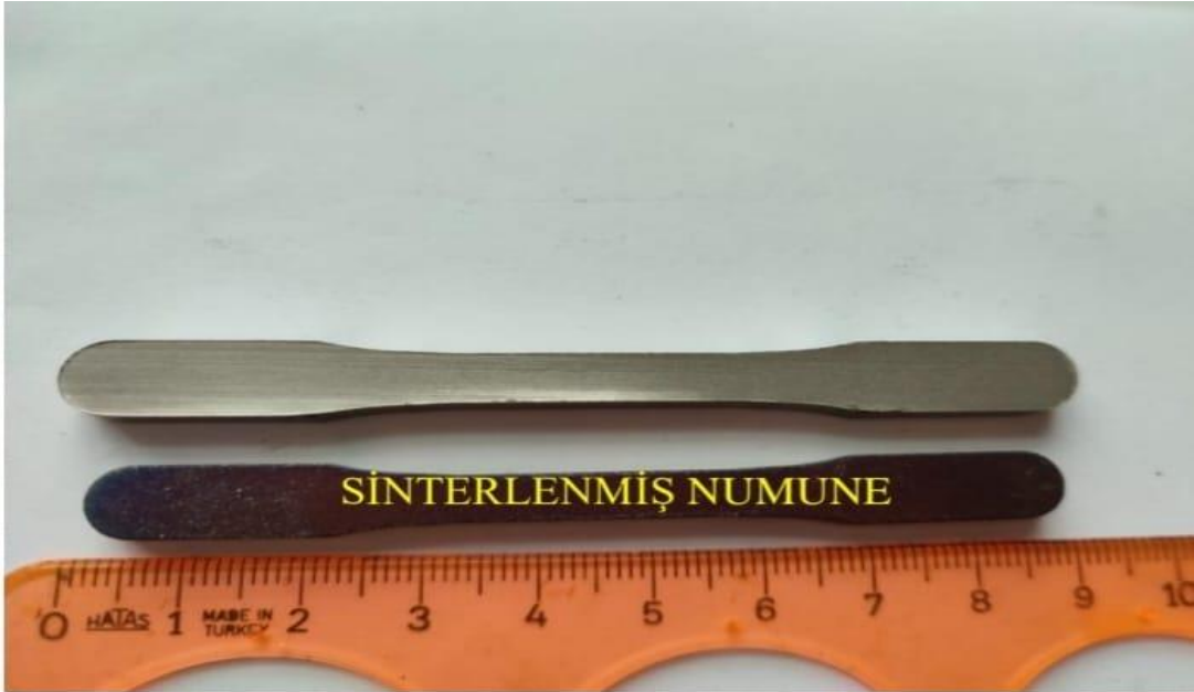
Şekil 3.15. Sinterleme öncesi ve sinterleme sonrası çekme numuneleri
