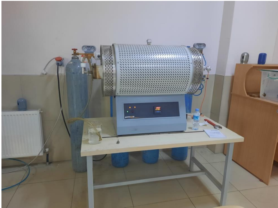
Şekil 3.10. Sinterleme işleminin yapıldığı fırın
