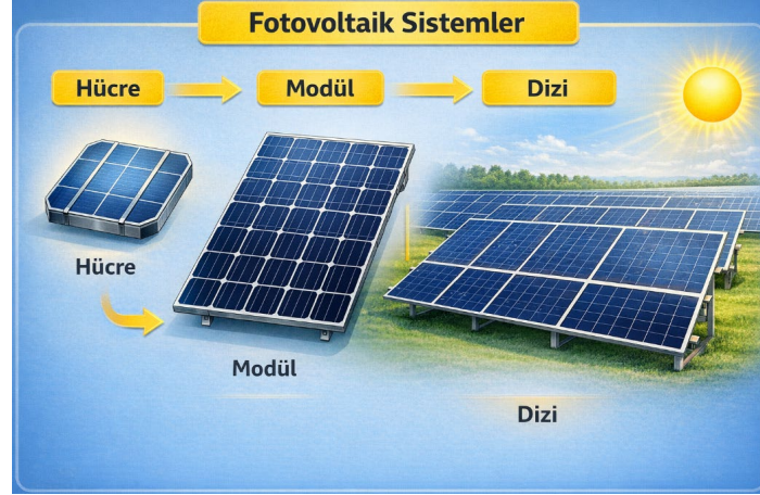
Şekil 3.7. PV sistemlerin hücre, modül ve dizi yapısındaki hiyerarşik bileşimi
