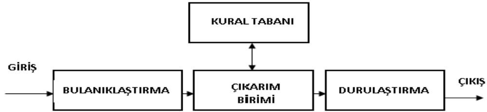
Şekil 2. 2. Bulanık Mantık Sisteminin Yapısı
