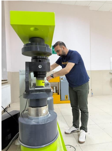
Şekil 3.4. Jeopolimer harç numuneleri basınç dayanım testi cihazı
