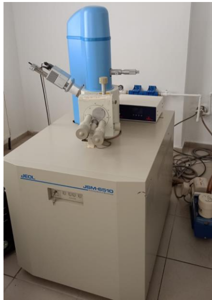
Şekil 3.6. SEM görüntüleme analizi ve deney cihazı
