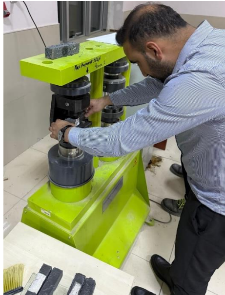
Şekil 3.3. Jeopolimer harç numuneleri üzerinde yapılan eğilme dayanım testi görüntüsü
