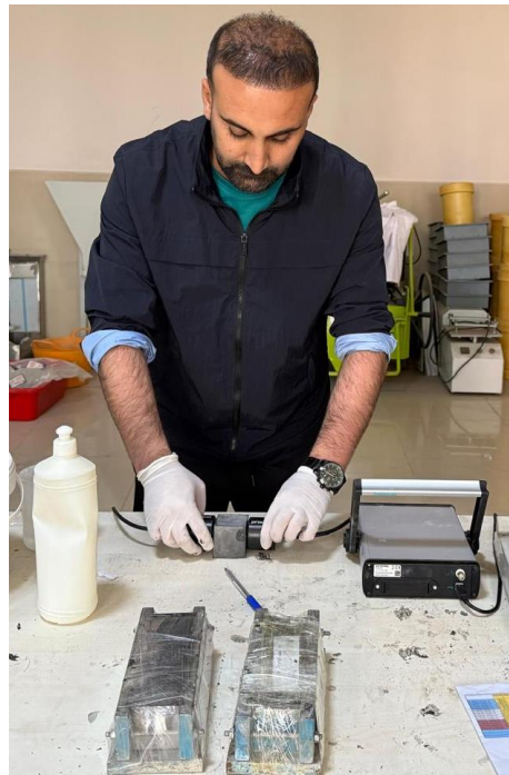
Şekil 3.5. Jeopolimer harç numunelerinde ultra ses geçiş hızının testi
