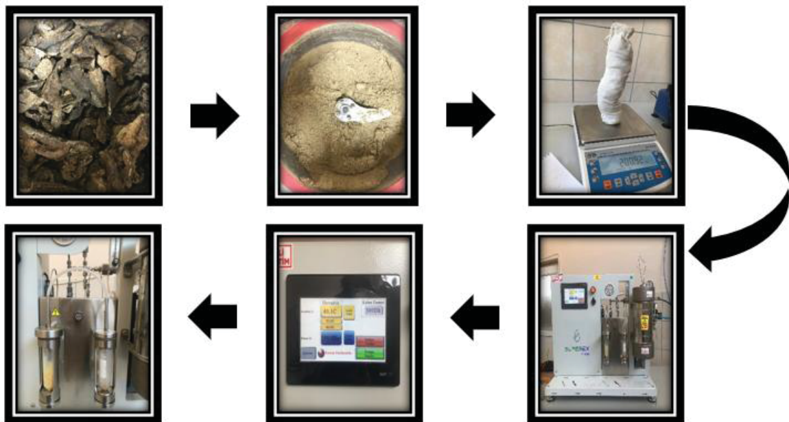
Şekil 3.2. Propolis ekstraksiyon sürecinin şematik gösterimi
