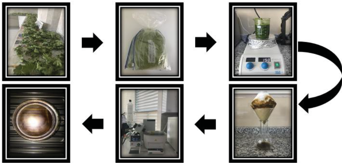
Şekil 3.1. Alchemilla persica ekstraksiyon sürecinin şematik gösterimi
