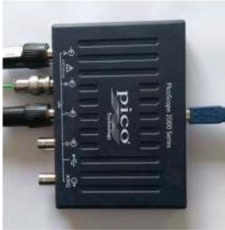
Şekil 3.7. PicoScope marka 2406B Model 4 kanallı Osiloskop
