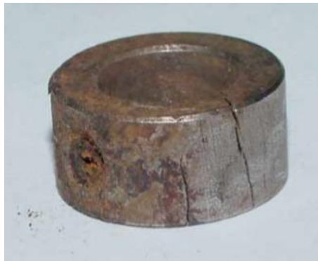
Şekil 1.9. Gerilim korozyon çatlak oluşmuş metal malzeme (URL-2, 2025)
