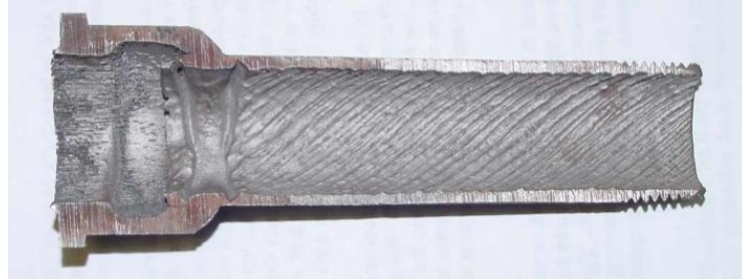
Şekil 1.10 Erozyon korozyonuna uğramış metal boru kesiti (URL-2, 2025)
