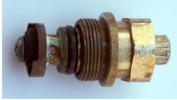
Şekil 1.7. Seçimli korozyona uğramış pirinç valf (URL-2, 2025)
