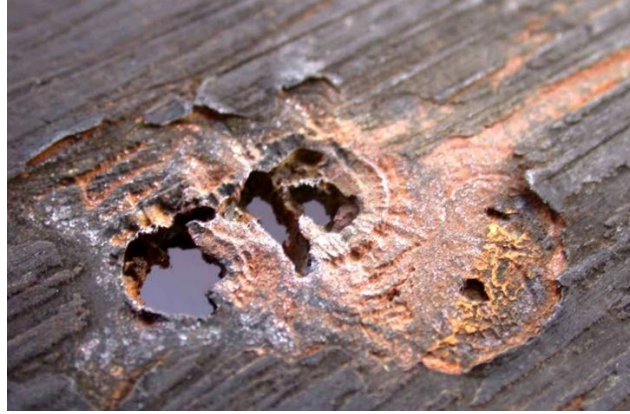
Şekil 1.5. Çukur korozyonuna uğrayan metal yüzey (URL-2, 2025)
