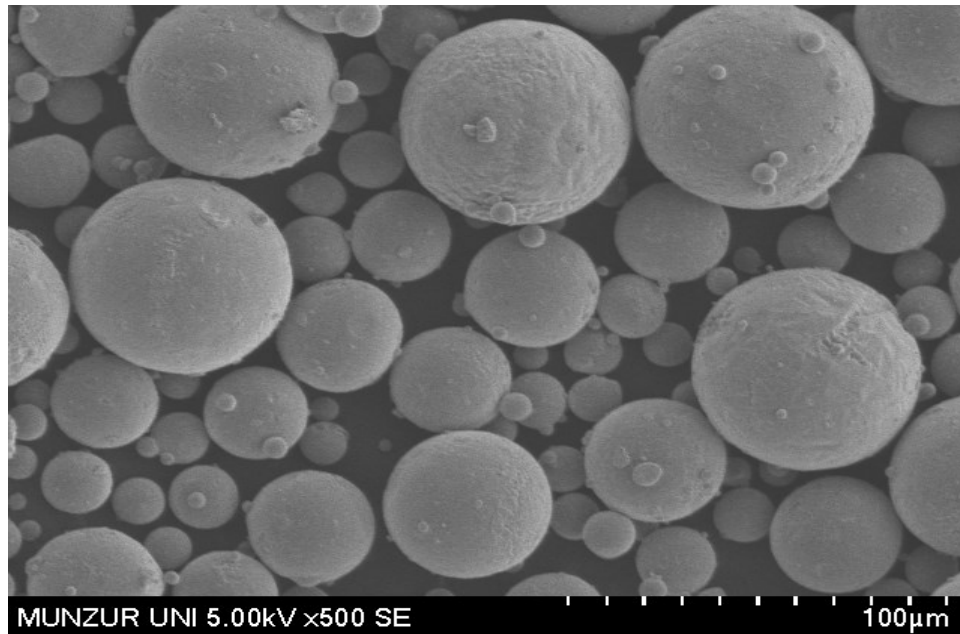
Şekil 6.2. AlSi10Mg tozundan alınan SEM fotoğrafı
