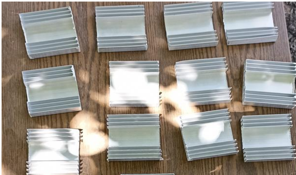
Şekil 4.4. 80x80 mm kare şekilli, 20mm derinlikli alüminyum kanatlar
