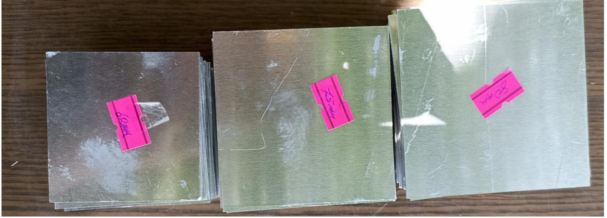
Şekil 4.5. Farklı boyutlardaki kare şekilli alaşımlı alüminyum yayıcı örnekleri
