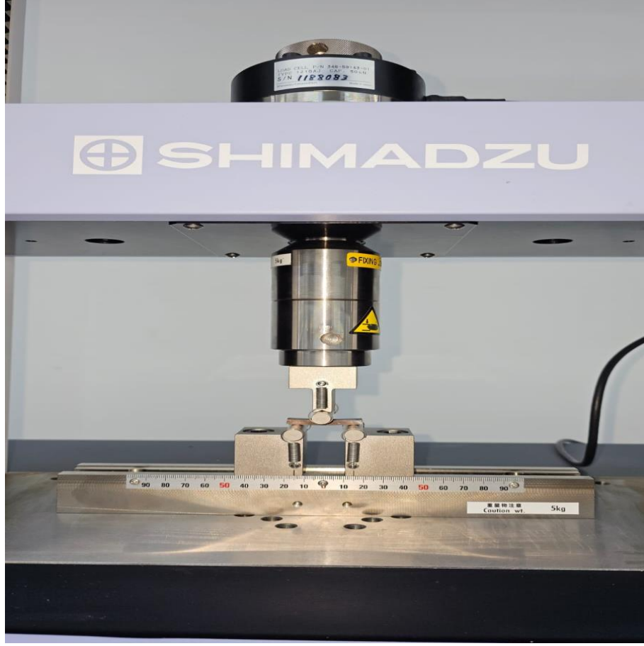
Şekil 7.9. Üç nokta eğme test cihazı
