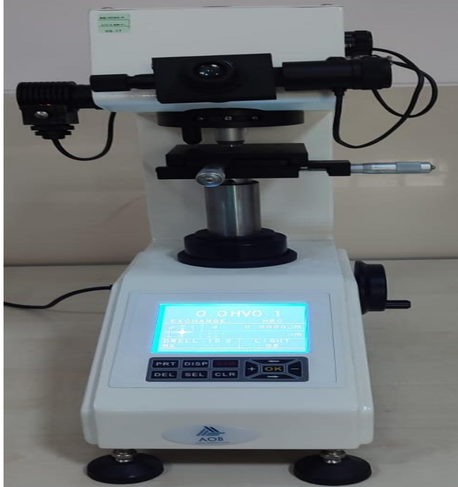
Şekil 7.8. Vickers mikrosertlik ölçüm cihazı
