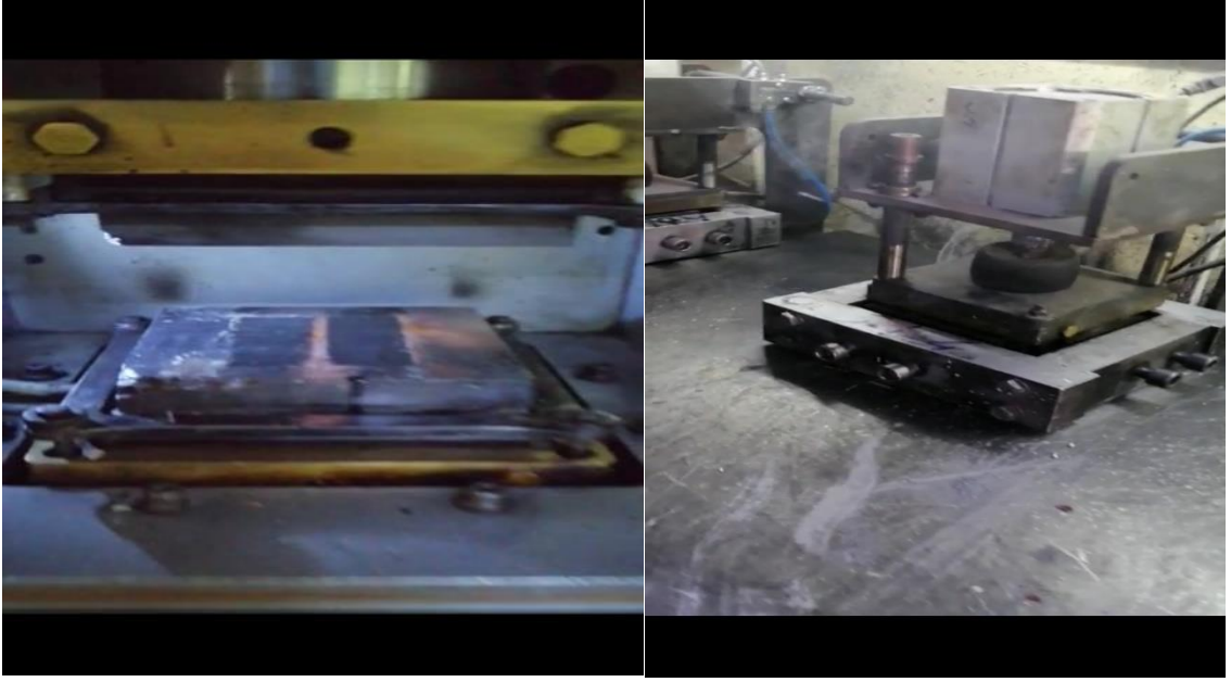
Şekil 7.5. SPS işleminin yapıldığı makine
