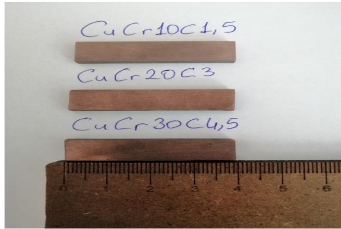
Şekil 6.6. SPS’de 40x10x4 mm ölçülerinde hazırlanan numuneler
