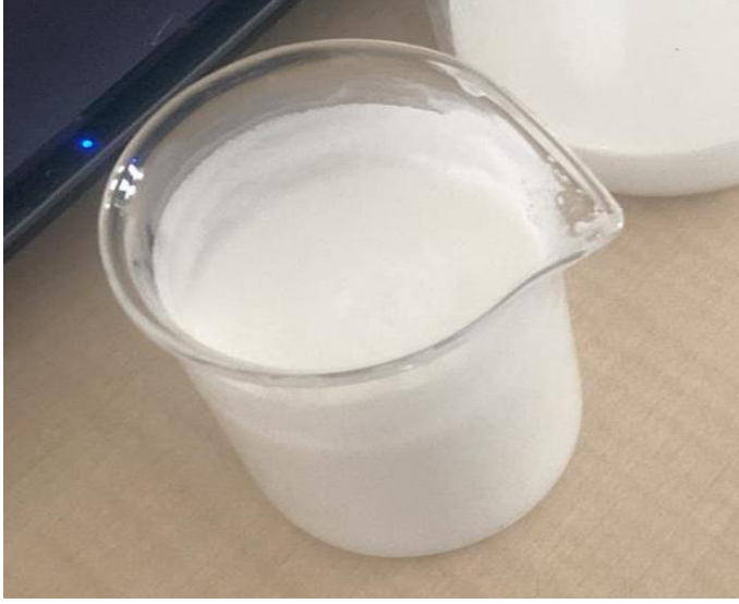
Şekil 6.16. MMY-Emülsiyon (mineral yağ + su) kesme sıvısının hazırlanışı
