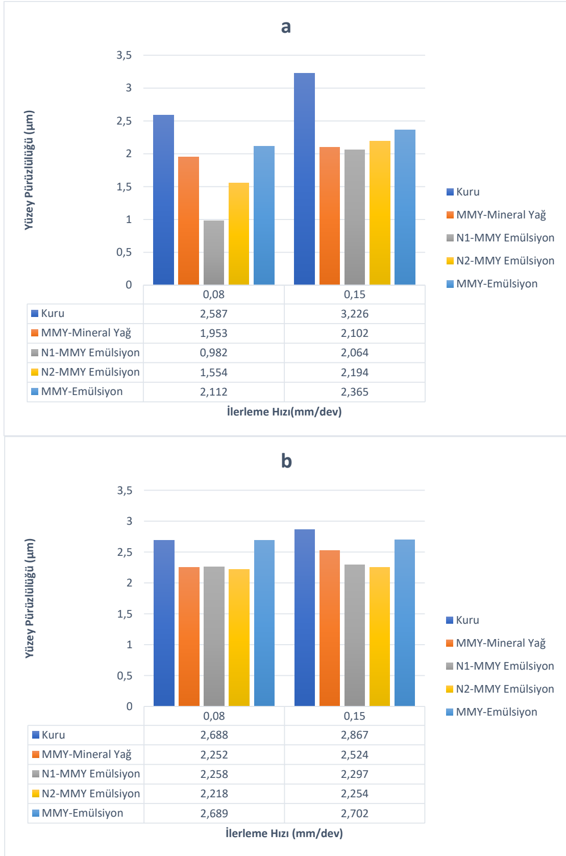
Şekil 7.2. ( a ) V_c = 120 m/dak, f_n=0,08 ve f_n=0,15 mm/dev; ( b ) V_c = 150 m/dak, f_n=0,08 ve f_n=0,15 mm/dev Farklı C/L koşullarının ilerleme hızlarına göre yüzey pürüzlülüğü sonuçları
