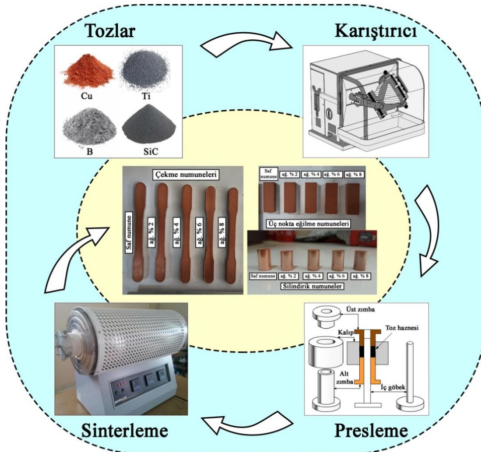
Şekil 6.1. Kompozit malzeme üretim şeması
