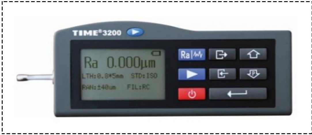
Şekil 6.18. Deneylerde kullanılan yüzey pürüzlülüğü ölçüm cihazı
