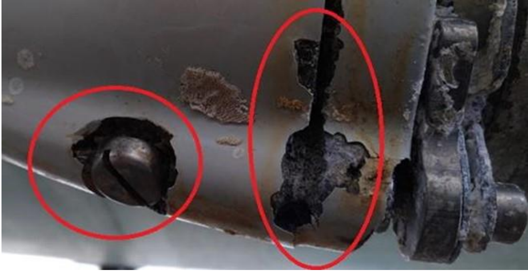
Şekil 1.2. Sudaki bir teknenin galvanik korozyonu (URL-2 2018)
