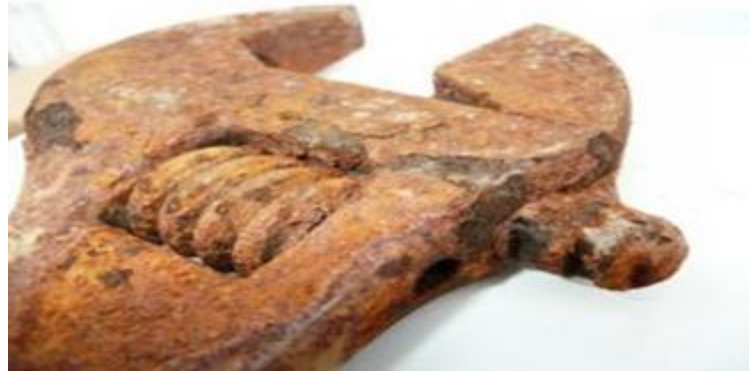
Şekil 1.1. Homojen korozyona uğramış yıldız anahtar (URL-1 2018)
