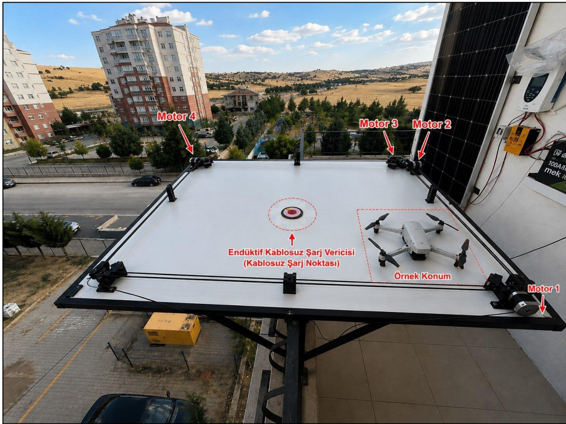
Şekil 3.6. İHA'nın platform üzerine örnek bir iniş gerçekleştirdiği konum ve manyetik şarj bölgesine göre başlangıç konumu gösterilmektedir
