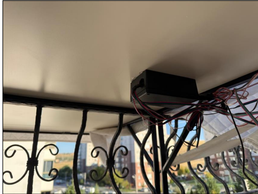
Şekil 3.5. ESP32 tabanlı kontrol birimi ve elektronik bağlantıların muhafazasıyla beraber platformun alt tarafına montajı
