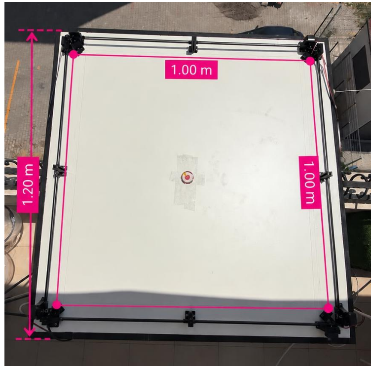
Şekil 3.1. Platformun genel ölçüleri ve İHA için kullanılabilir iniş alanı
