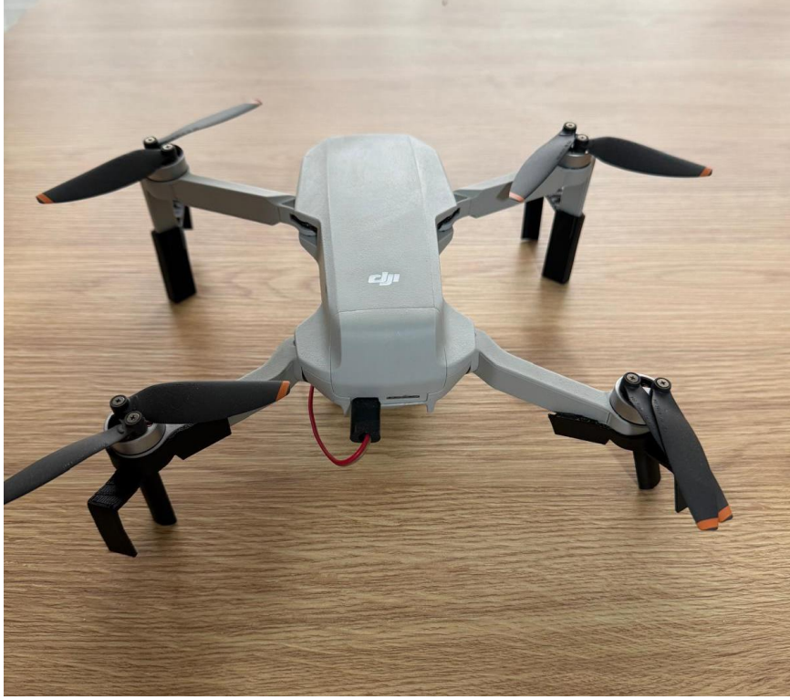
Şekil 3.3. İHA iniş takımlarına eklenen merkezleme aparatları
