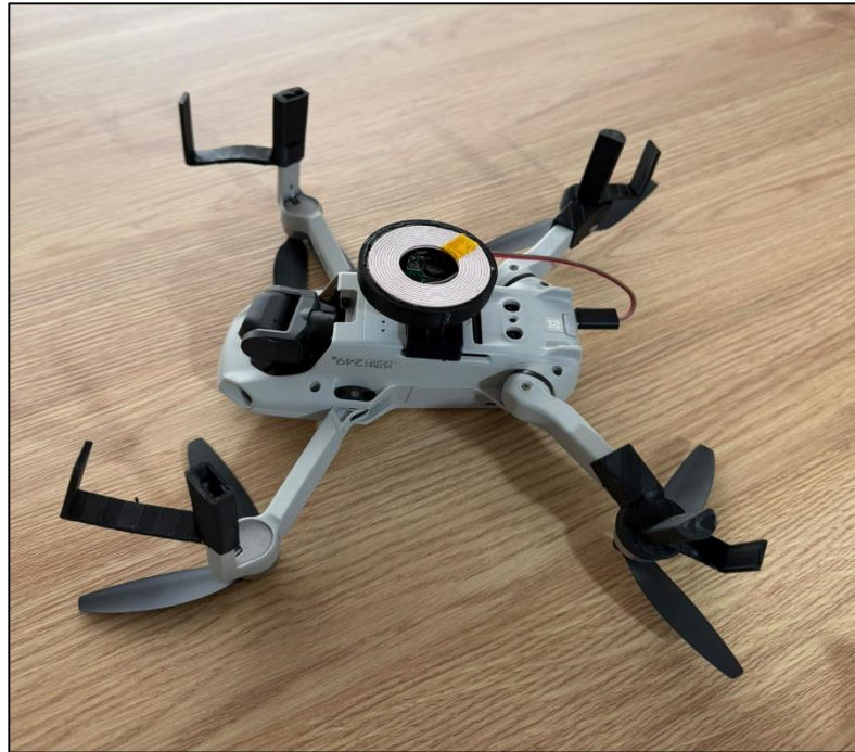
Şekil 3.10. İHA üzerine monte edilen, alıcı (RX) bobininin genel görünümü
