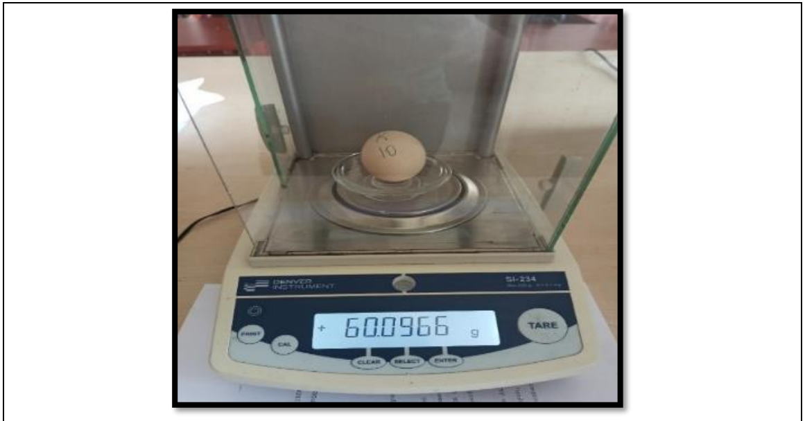
Şekil 3.2. Hassas terazi ile yumurta ağırlığı ölçümü
