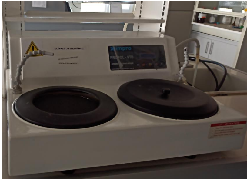
Şekil 3.6. Zımparalama ve parlatma cihazı
