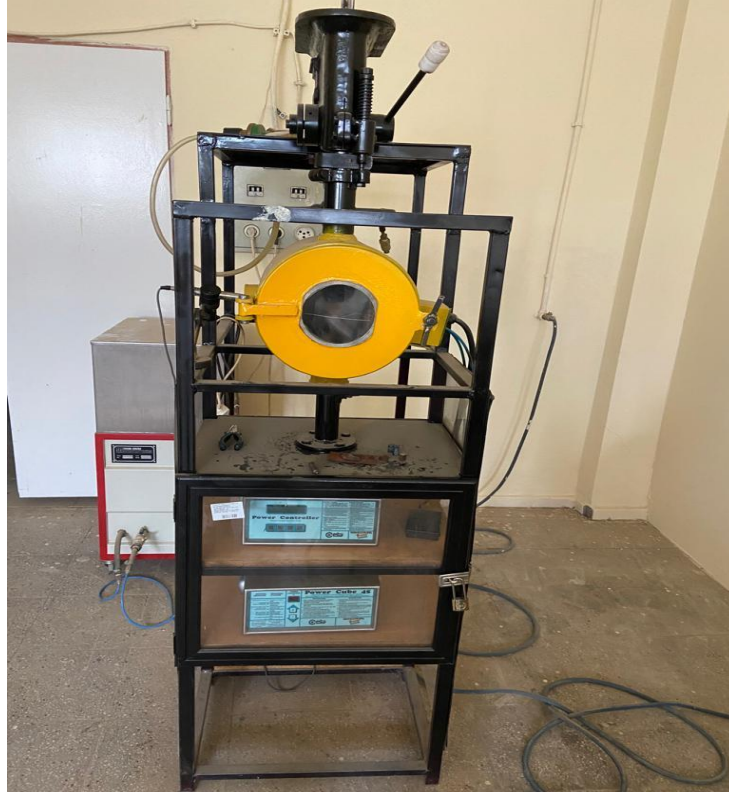
Şekil 3.5. Deneyde kullanılan İndüksiyon kaynak makinesi
