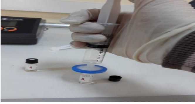
Şekil 3.2.11. Yağ asitlerini içeren hegzan fazının filtreden geçirilerek vialle alınması
