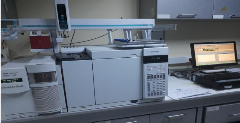
Şekil 3.2.13. Örneğin GC viallerine alınarak GC-MS cihazında analiz edilmesi
