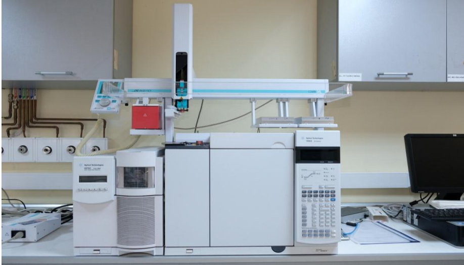
Şekil 3.2.23. GC-MS (Gas Chromatography-Mass Spectrometry) cihazında naftalin tayininin yapılması
