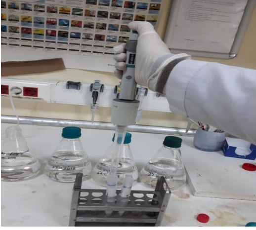
Şekil 3.2.8. Oluşan yağ asidi metil esterlerinin 2,5 ml hekzan ile ekstre edilmesi
