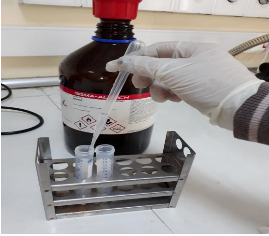
Şekil 3.2.9. Hekzan fazı üstten pastör pipeti ile alınarak 2,5 ml %2'lik \text{Na}_2\text{CO}_3 ile muamele edilmesi
