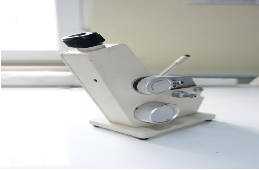
Şekil.3.2.31. Refraktometre ile balın neminin veya baldaki su miktarının % olarak ölçülmesi
