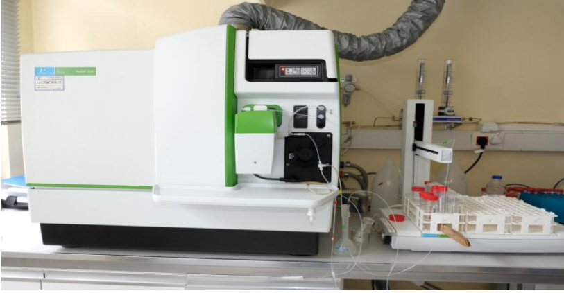
Şekil 3.2.24. ICP-MS (Inductively Coupled Plasma – Mass Spectrometer) Balda ağır metal analizinin yapılması
