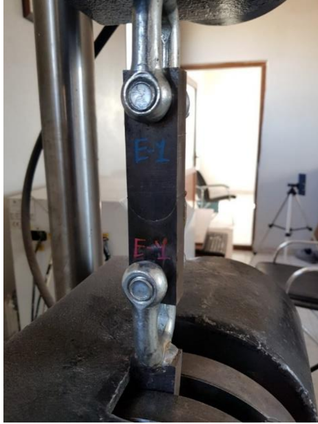
Şekil 2.9. Deney numunesinin test cihazına bağlanması
