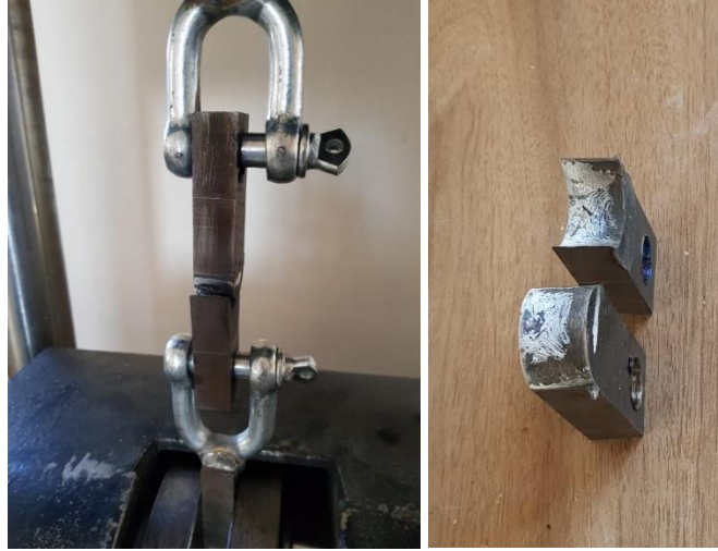
Şekil 2.10. Çekme deneyi sonucunda bağlantısının kopması
