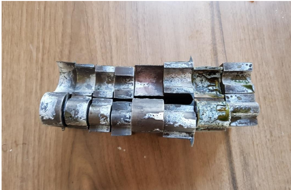
Şekil 2.12. Çekme deneyi gerçekleştirilmiş numuneler
