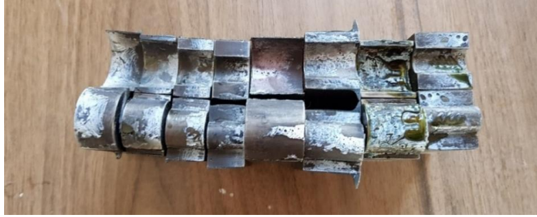
Şekil 3.1. Çekme deneyi sonucu numunelerin son hali
