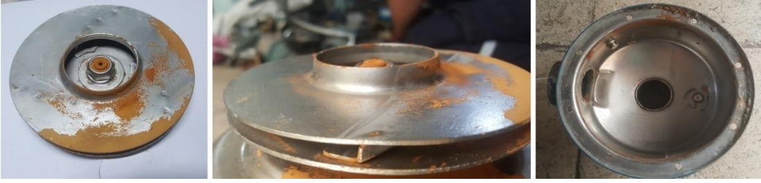
Şekil 2.23. Pompa çarkı ve salyangozda 60 gün sonunda durumu
