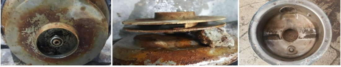
Şekil 2.25. Pompa çarkı ve salyangozda 120 gün sonunda durumu
