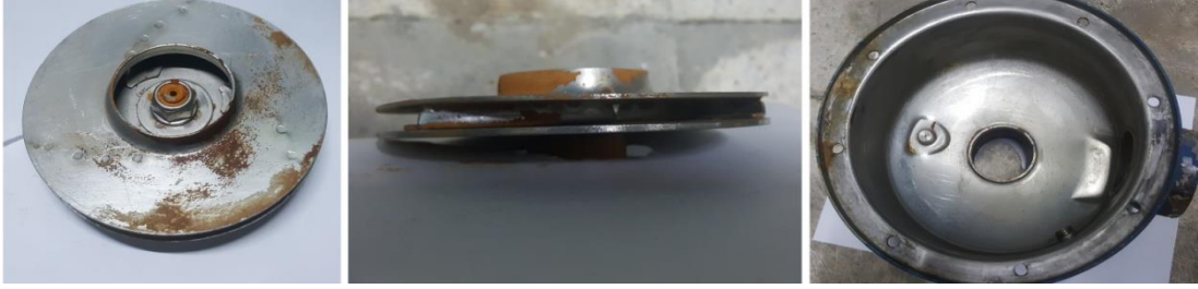
Şekil 2.22. Pompa çarkı ve salyangozda 30 gün sonunda durumu
