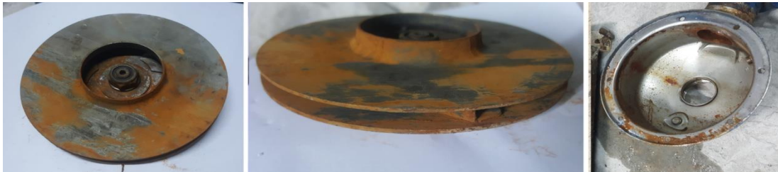
Şekil 2.24. Pompa çarkı ve salyangozda 90 gün sonunda durumu
