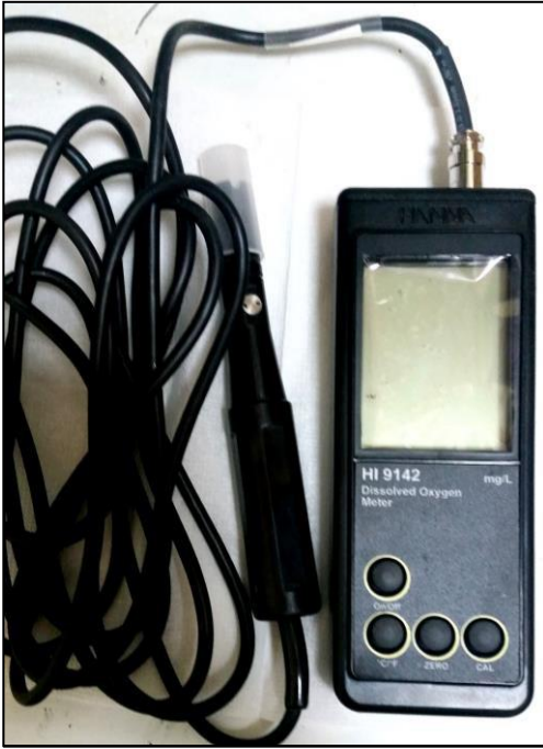
Şekil 2.6. Oksijen miktarını ölçen HANNA HI-9142 oksijen metre
