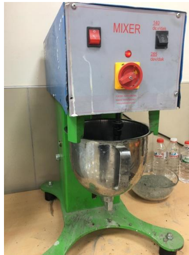
Şekil 3.2. Makro boyutlu NiNPs'lerini hazırlama mikseri
