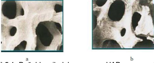
Şekil 5.1. Doğal kemik dokusunun ve HAP yapısının SEM görüntüleri a) kemik b) HAP [5]
