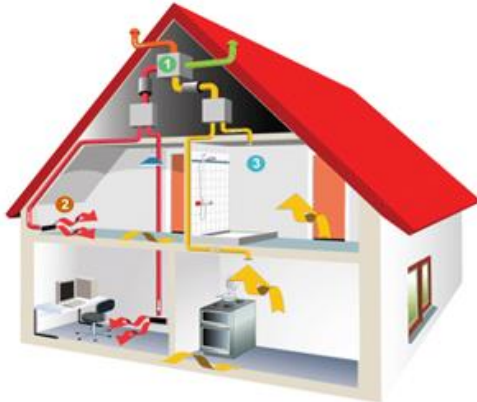
(1) Isı geri kazanım cihazı (2) Taze hava istenen mahaller (3) Kirliliği tahliye edilmesi istenen mahaller
