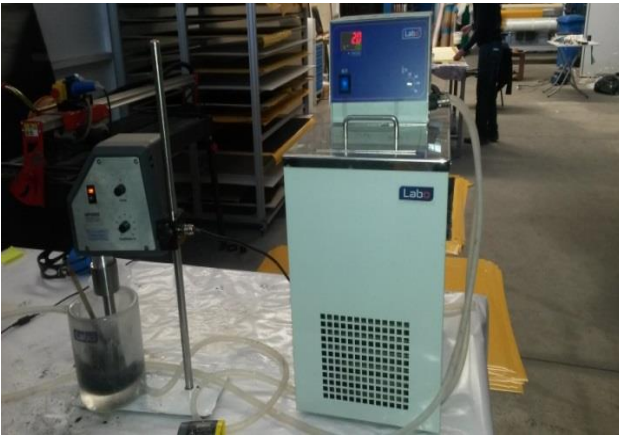
Şekil 1. Ultrasonik karıştırıcı ve soğutma çevrimi
