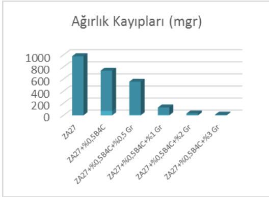
Şekil 5. ZA27 Alaşım ve kompozitlerinin 10N-48 dk. aşınma sonrası ağırlık kayıpları
