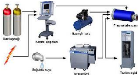
Şekil 5.6. Plazma sprej düzeneği temsili gösterimi [3].
