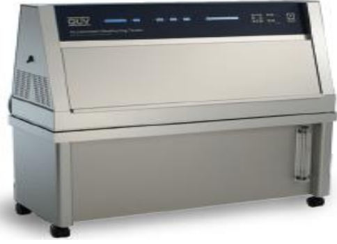
Şekil 1. QUV Hızlandırılmış yaşlandırma cihazı [3].
