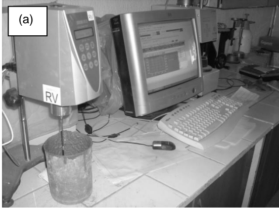
Şekil 4. Polimer esaslı epoksi harçlarda a: yayılma deneyi ve b: değerlerinin ölçülmesi
