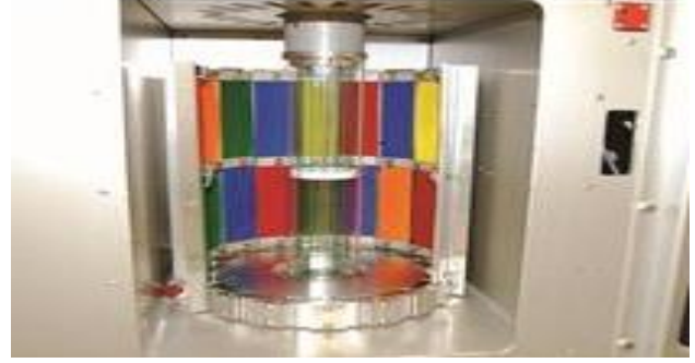
Şekil 2. Xenon yaşlandırma cihazı [7].
