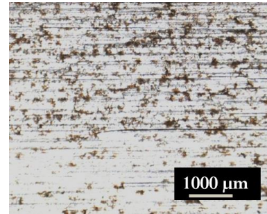
Şekil 2. Çelik sürtünme öncesi görüntüsü (OM)
