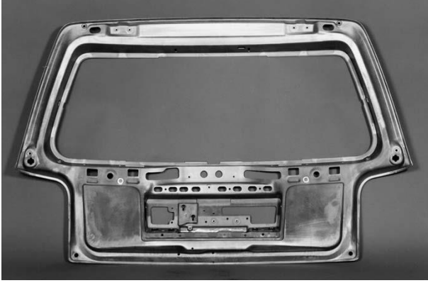
Şekil 7. VW 3L Lupo modelinin magnezyum-alüminyum kompozit yapı bagaj kapağı [27].
