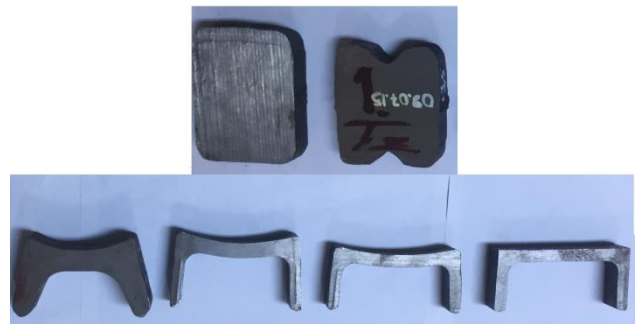
Şekil 22. Gerçek Üretimler Esnasında Alınan Numune Kesitler
