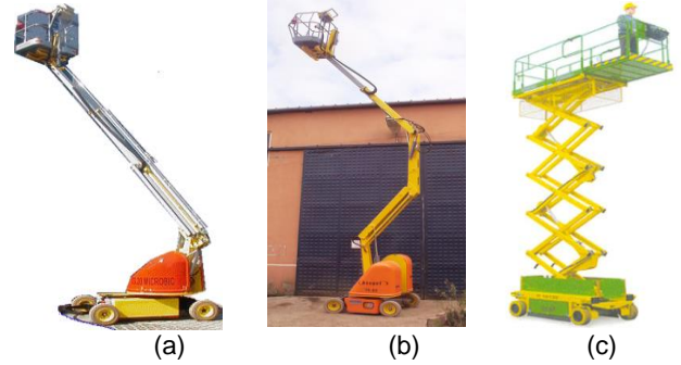
Şekil 1. Teleskobik (a), eklemli (b) ve makaslı kaldırma sistemi (c) [2, 3].
