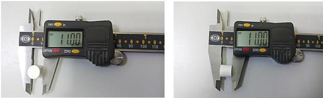
Şekil 2 British 7253 standartına göre peletlenmiş olan numunelerin boyutları
