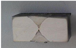
Şekil 2. Kaynak dikişi kesitinin makro görünümü
