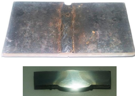
Şekil 3. Kaynak dikişi ve kesitinin makro görünümü.
