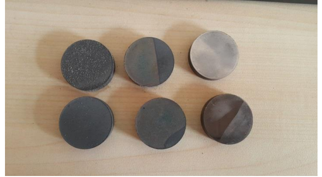
Şekil 4.1. AISI 1010 çeliğinin sinterlenmiş numune fotoğrafları.
