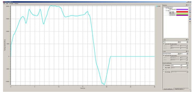
Şekil 37. 1. Prototip tasarımda kullanılan alt bükme topuna ait moment grafiği
