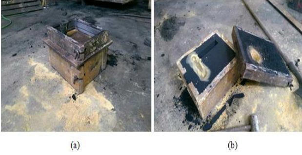
Şekil 1. (a) Alt ve üst derecenin kalıplanması, (b) Yolluk ve giderici kısmının boyanması.
