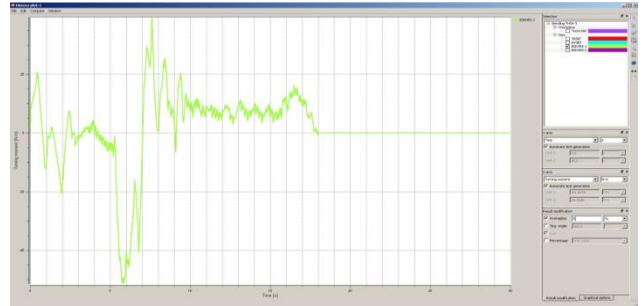
Şekil 38. 1. Prototip tasarımda kullanılan sağ yan bükme topuna ait moment grafiği
