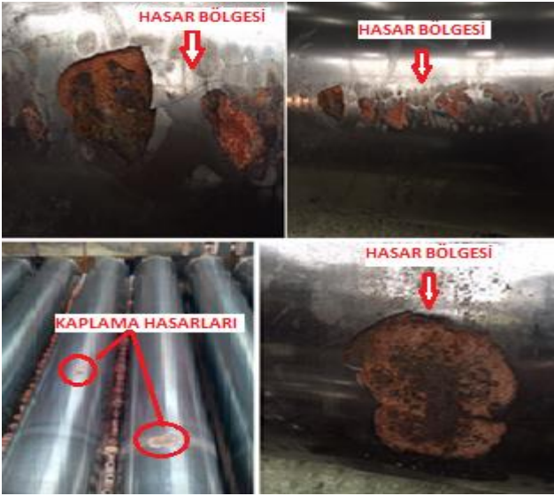
Şekil 3. Roll yüzeylerinde meydana gelen kaplama kaynaklı kusurların görünümü
