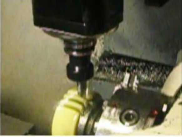
Şekil 5. Konveks-konkav dişlinin CNC freze tezgahında işlenmesi[11]
