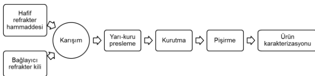
Şekil.1 Refrakter tuğla üretimi için deneysel akış şeması.
