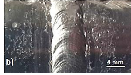
Şekil 4. Kaynak dikişlerinin üst yüzey makro görüntüsü, a) Orbital TIG, b) Manuel TIG
