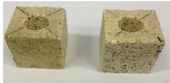
Şekil 2.3 Curuf Atak Testleri İçin Hazırlanan Silimanit Refrakter Numuneleri
