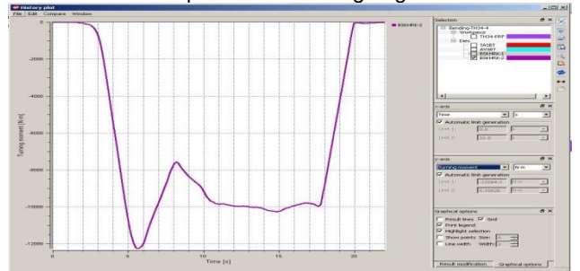
Şekil 48. 2. Prototip tasarımda kullanılan sol yan bükme topuna ait moment grafiği
