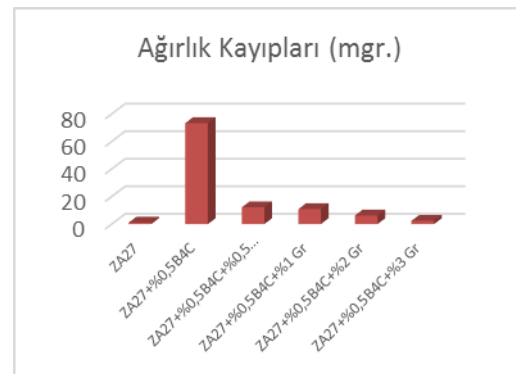
Şekil 4. ZA27 Alaşım ve kompozitlerinin 2N-96 dk. aşınma sonrası ağırlık kayıpları
