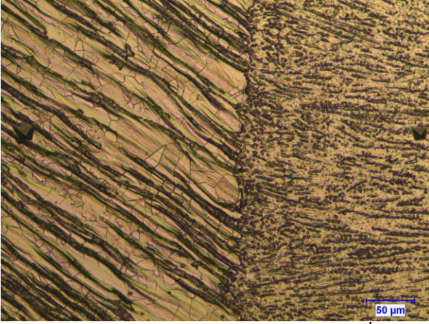
Şekil 3. Kaynak Metali ve ITAB Bölgesi Sertlik İzi Optik Fotoğrafi
