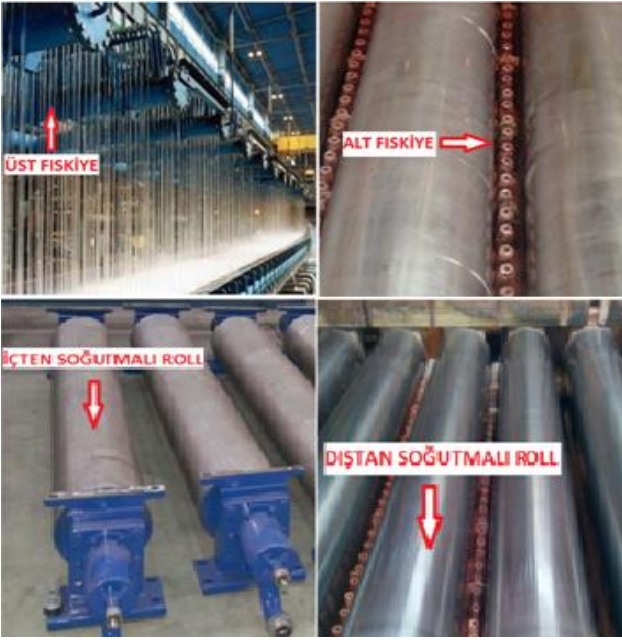
Şekil 2. Duşlu masa rollerindeki soğutma kısımları
