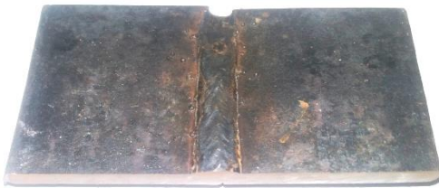
Şekil 2. Kaynak dikişi makro görünümü.
