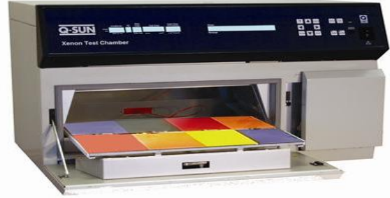
Şekil 3. Q-SUN Xenon yaşlandırma cihazı [7].
