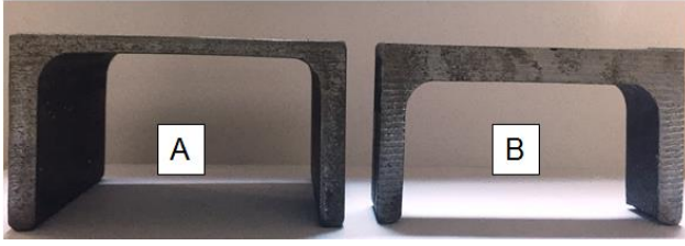
Şekil 23. A: PFC100 B: Elde Edilen Özel Kesitli Profil
