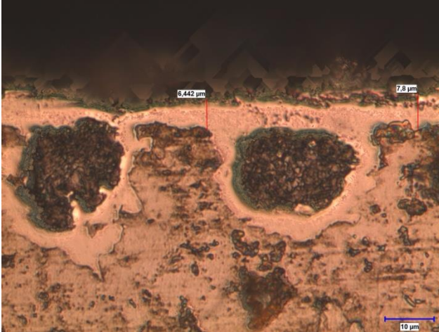
Şekil 3. 1000 °C'lik sıcaklıkta CrVC kaplanan numunede grafitlerin optik fotoğrafı
