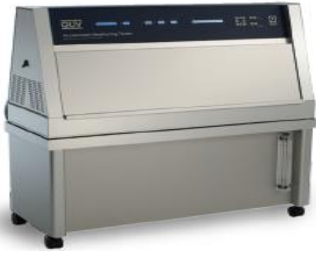
Şekil 1. QUV Hızlandırılmış yaşlandırma cihazı [11].
