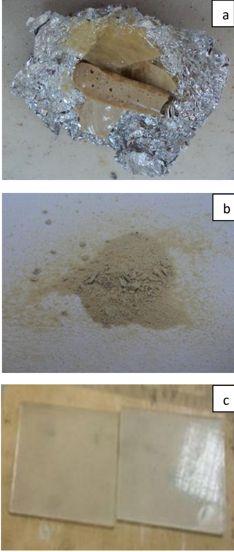
Şekil 4. Ergitme sonrası PET'in katı (a), toz(b) ve kaplanmış(c) halinin görüntüleri
