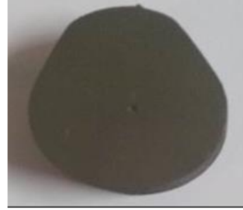
Şekil 2. Mikroyapı incelemesi yapılan kam mili üzerinde bulunan kam kesiti
