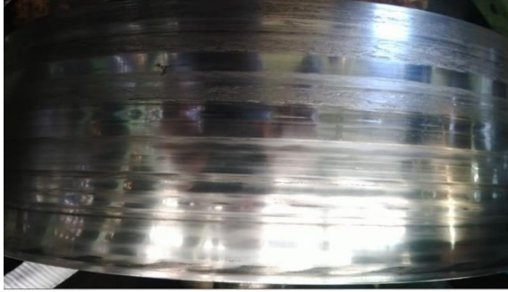
Şekli 1. Aşınmış ve ömrünü tamamlamış boru üretim hattı baskı makarasının yüzey görünümü
