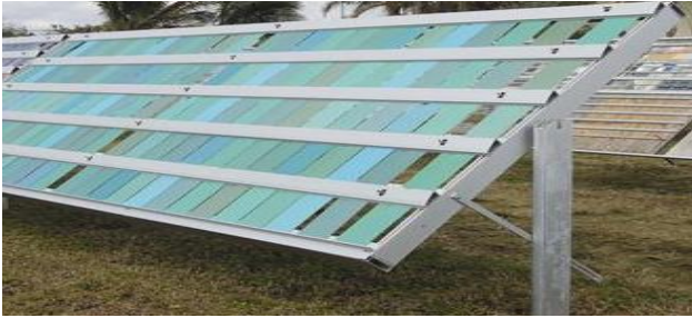
Şekil 6. Açık havaya maruz kalma rafları ve deney örnekleri [12].
