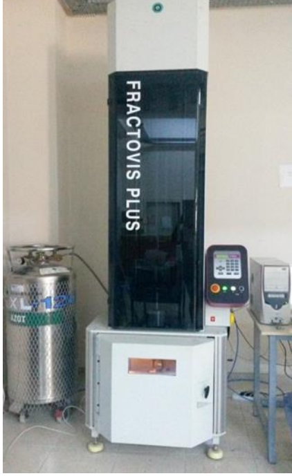
Şekil 2. Düşen ağırlık darbe test düzeneği
