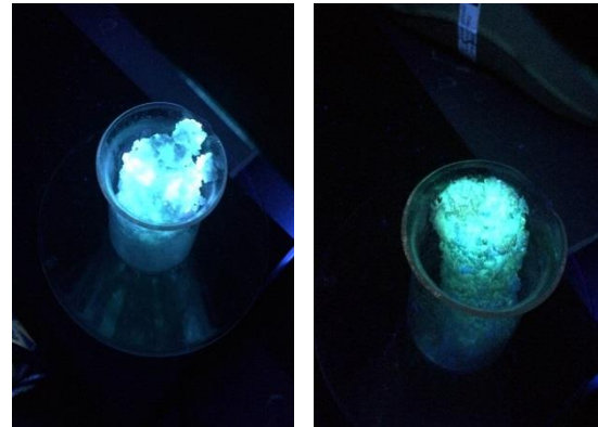
Şekil 2. 3MAI_2O_4 yapısında sentezlenen fosforesans bileşiklerin UV lambası altında ve uyarıldıktan sonra karanlıktaki ışımaları
