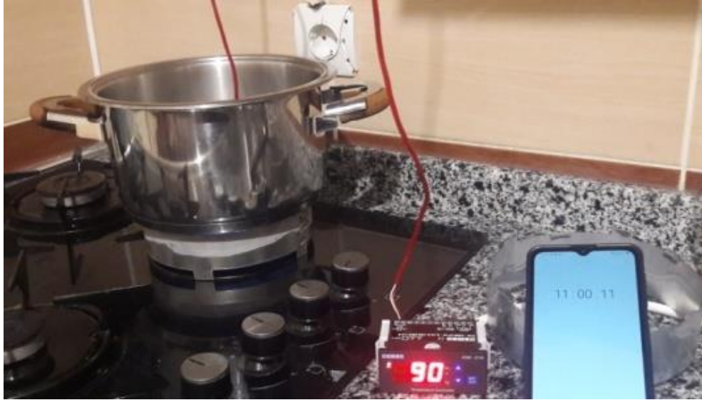
Şekil 4.10. Ø162 x 50 mm kaplama ilk durum ve son durum su sıcaklığı süreleri
