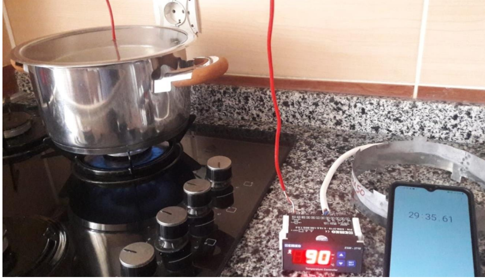
Şekil 4.24. 4 litre için normal ocak ilk durum ve son durum su sıcaklığı süreleri
