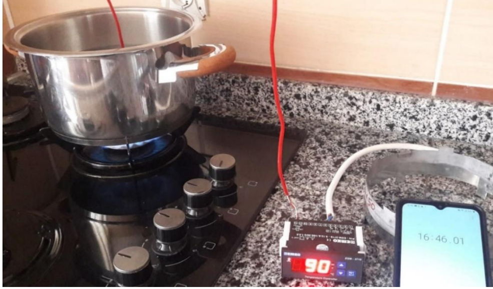
Şekil 4.20. 2 litre için normal ocak ilk durum ve son durum su sıcaklığı süreleri
