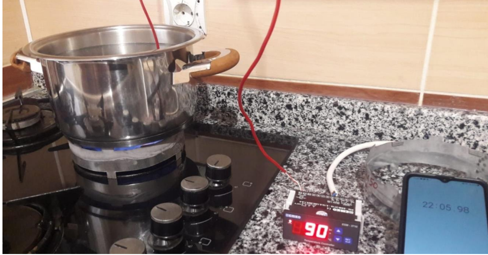
Şekil 4.23. 3 litre için kaplamalı ocak ilk durum ve son durum su sıcaklığı süreleri
