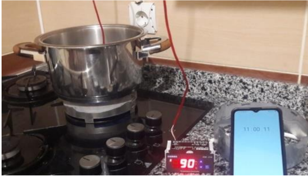
Şekil 4.17. Ø162 x 50 x 12 mm kaplama ilk durum ve son durum su sıcaklığı süreleri
