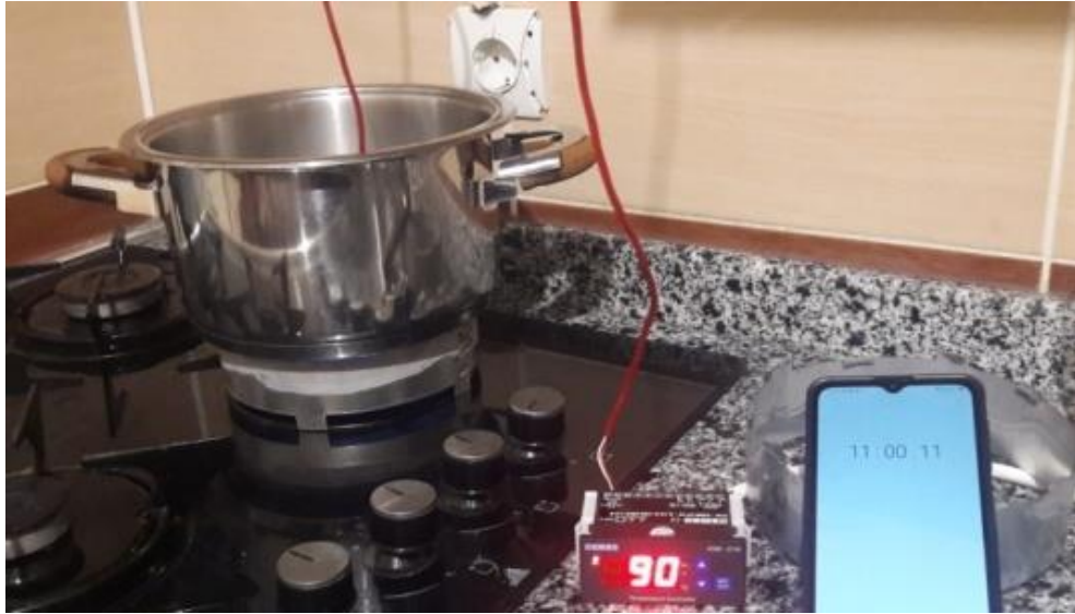
Şekil 4.14 Ø162 x 50 x 12 mm kaplama ilk durum ve son durum su sıcaklığı süreleri
