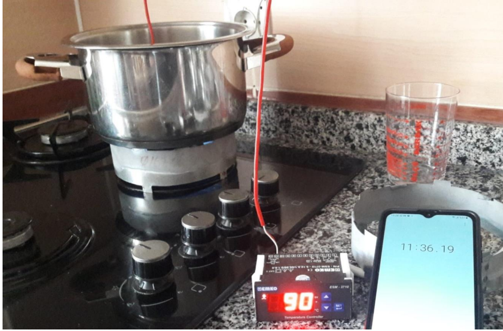
Şekil 4.19. Ø162 x 60 x 12 mm kaplama ilk durum ve son durum su sıcaklığı süreleri
