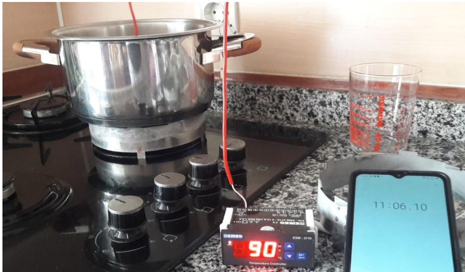
Şekil 4.13. Ø162 x 50 x 8 mm kaplama ilk durum ve son durum su sıcaklığı süreleri
