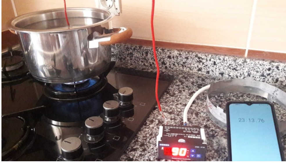
Şekil 4.22. 3 litre için normal ocak ilk durum ve son durum su sıcaklığı süreleri
