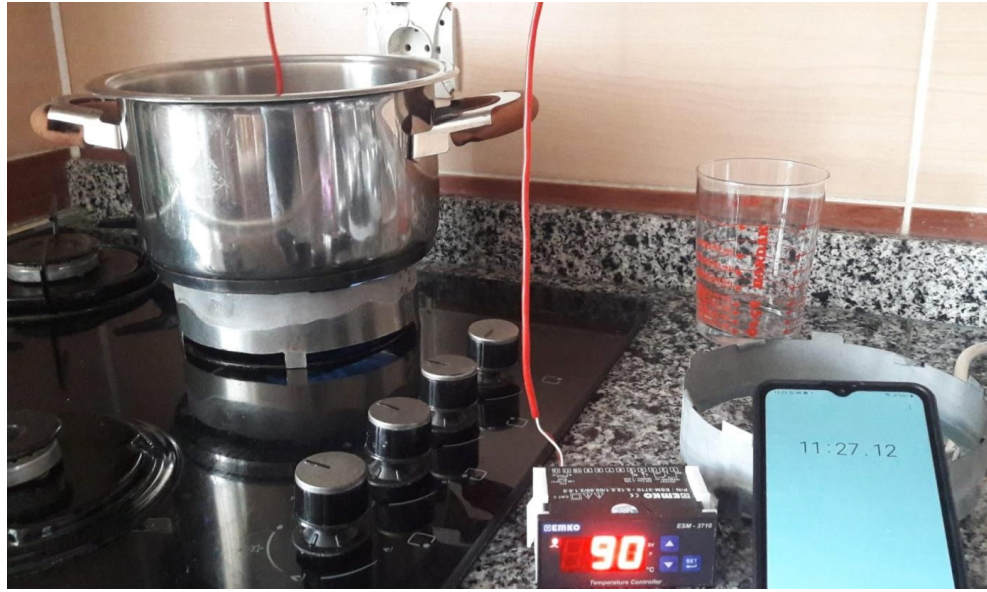
Şekil 4.18. Ø162 x 55 x 12 mm kaplama ilk durum ve son durum su sıcaklığı süreleri
