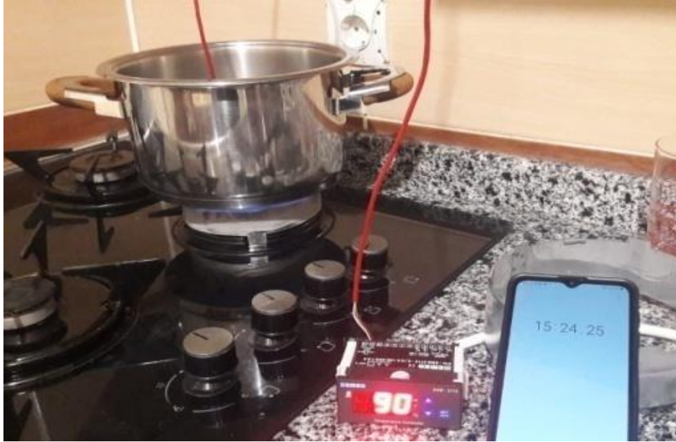
Şekil 4.12. Ø132 x 50 mm kaplama ilk durum ve son durum su sıcaklığı süreleri
