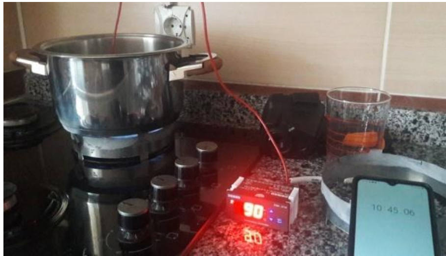
Şekil 4.16. Ø162 x 45 x 12 mm kaplama ilk durum ve son durum su sıcaklığı süreleri
