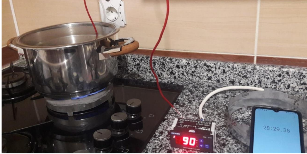
Şekil 4.25. 4 litre için kaplamalı ocak ilk durum ve son durum su sıcaklığı süreleri
