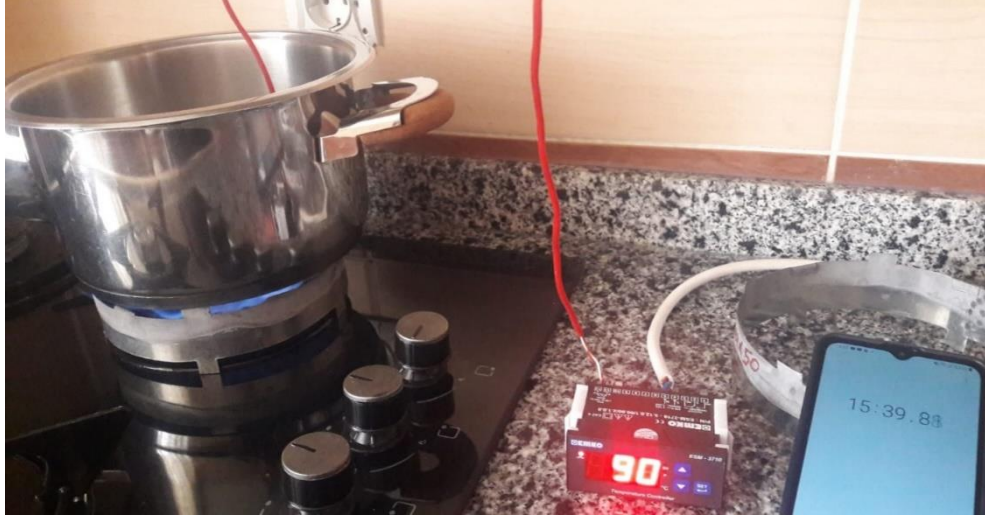
Şekil 4.21. 2 litre için kaplamalı ocak ilk durum ve son durum su sıcaklığı süreleri
