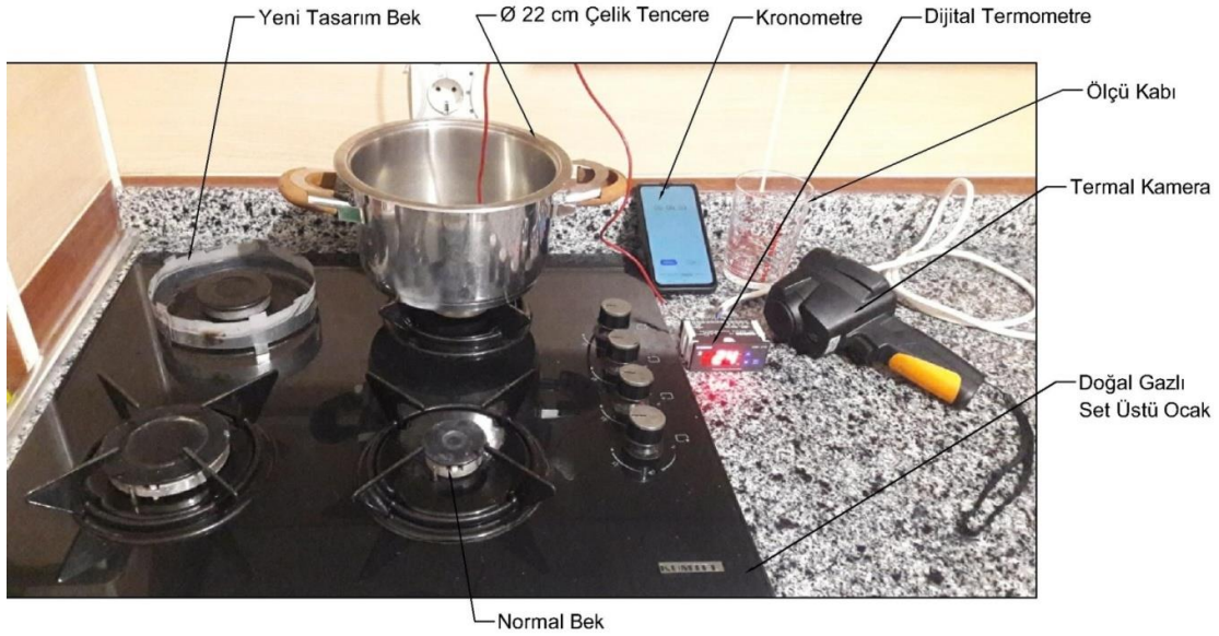
Şekil 4.1. Deney düzeneği genel görünüşü
