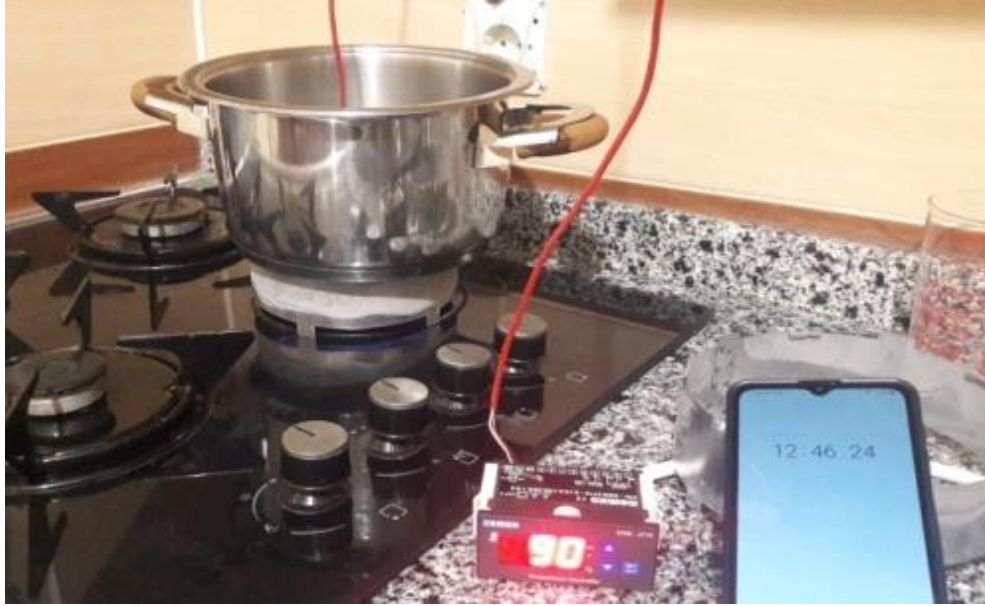
Şekil 4.11. Ø150 x 50 mm kaplama ilk durum ve son durum su sıcaklığı süreleri
