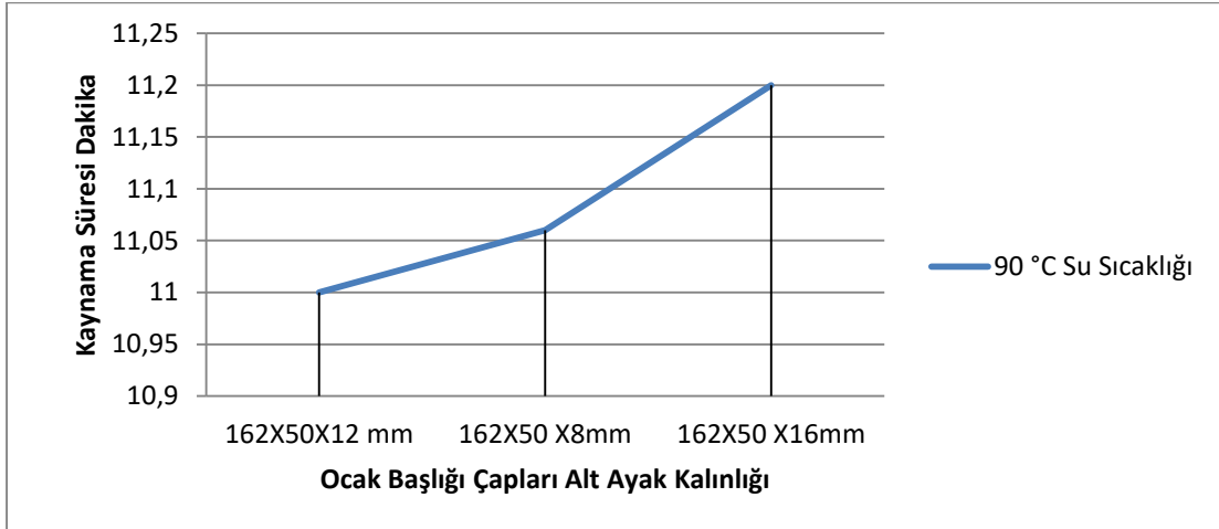
Şekil4.32. Ayaklarının kalınlıkları farklı tip kaplamalar için su sıcaklığı süreleri
