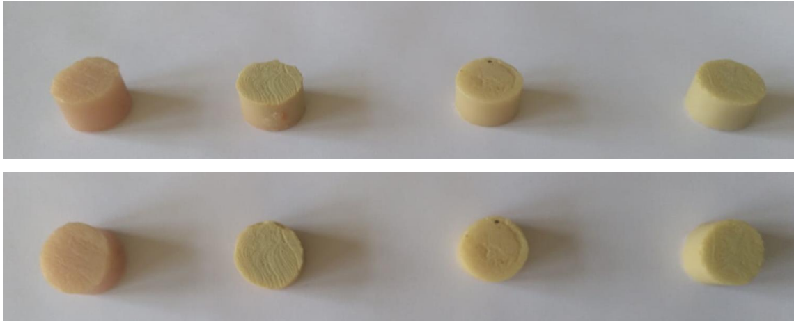
Şekil 3.19. %5, %10, %15 ve %20 oranlarında Bi 2 WO 4 ile katkılanmış polimer kompozitler
