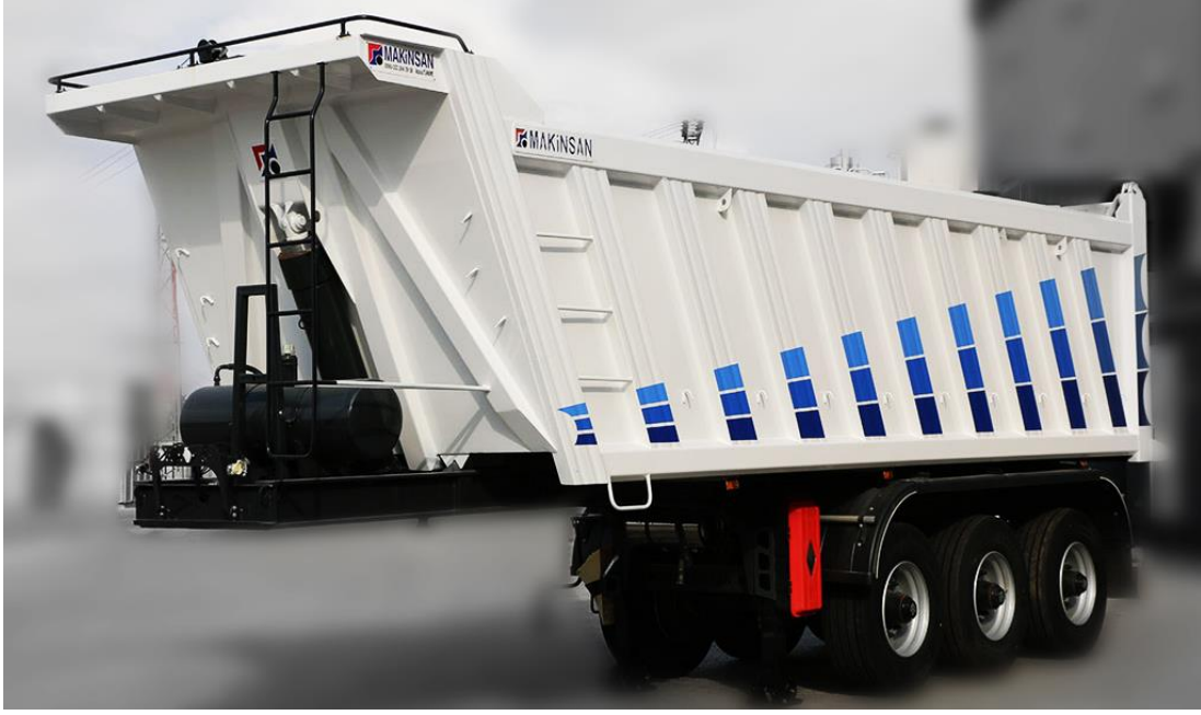
Şekil 1.30. Kaya tipi damper kasa donanımı örneği (URL-2)
