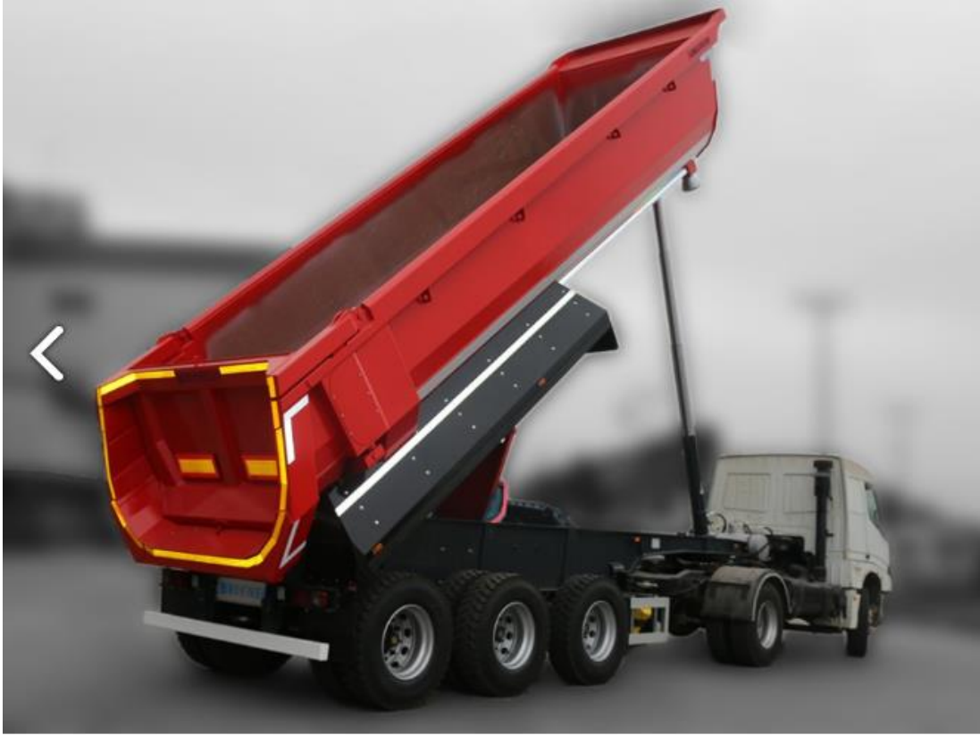
Şekil 1.28. Küvet tipi damper kasa donanımı örneği (URL-2)
