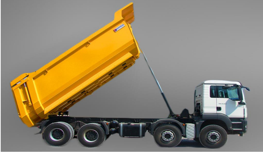
Şekil 1.26. Araç üstü damper kasa donanımı örneği (URL-2)
