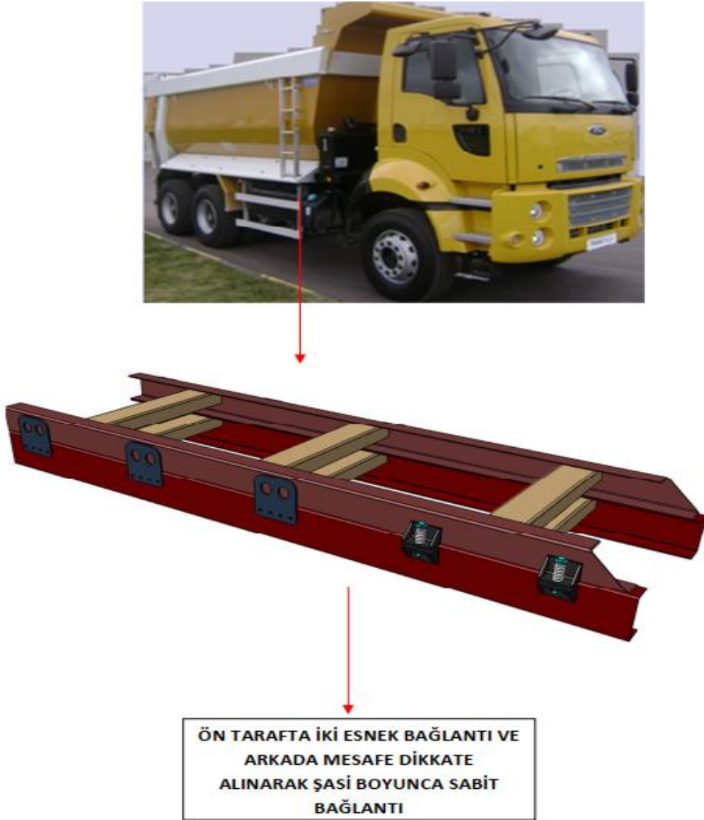
Şekil 1.40. Bağlantı plakaları yerleşimi (Akarsu 2012)
