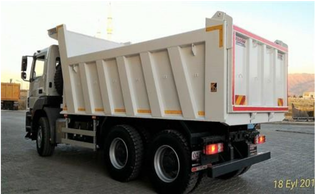
Şekil 1.22. Arkaya doğru devrilmeli damper kamyonları (Ford 2007)
