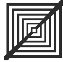
Şekil 15. Murray kanununa göre değişen kanal genişliğine sahip akış kanalı
