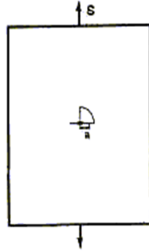
Şekil 3. Merkez çatlaklı (CCT) numunesi
