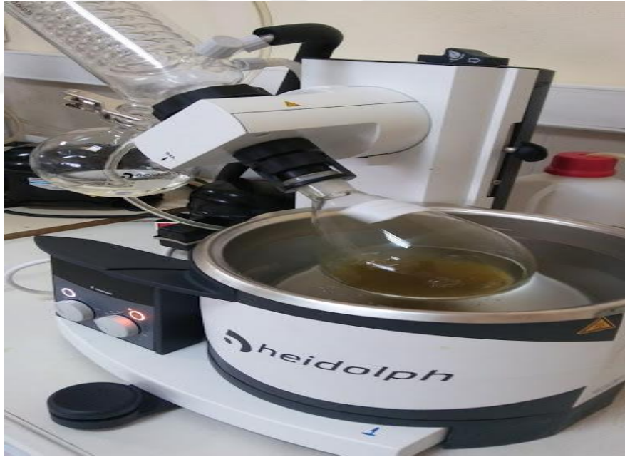
Şekil 3.4. Çözücü ihtiva eden bitki ekstralarının rotary evaporator ile çektilmesi
