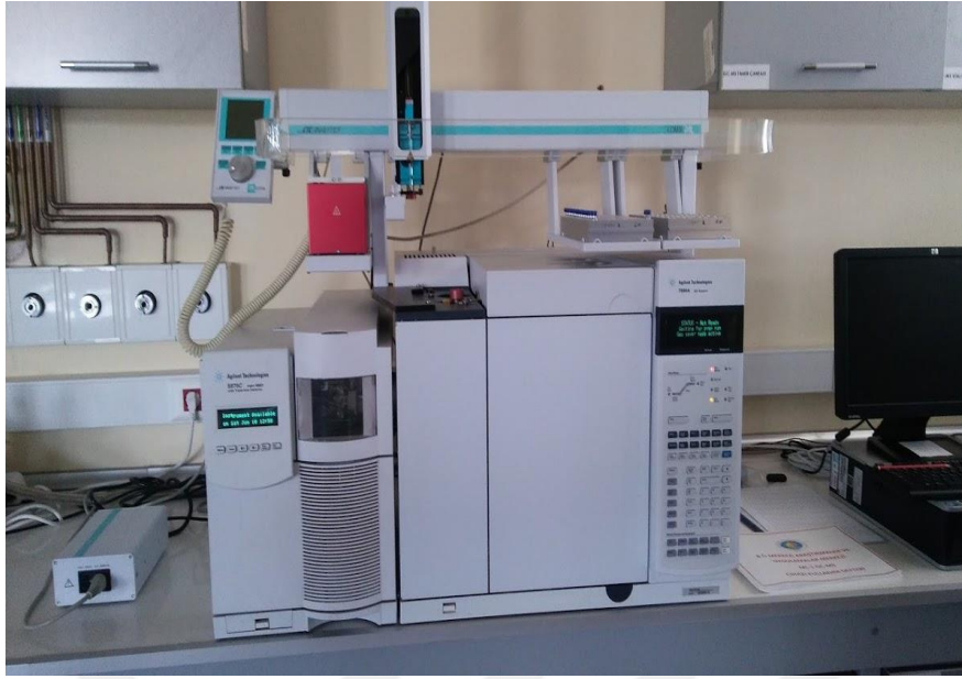
Şekil 3.9. Uçucu yağ bileşenleri miktarının tespitinde kullanılan HS-SPME/GS-MS cihazı.
