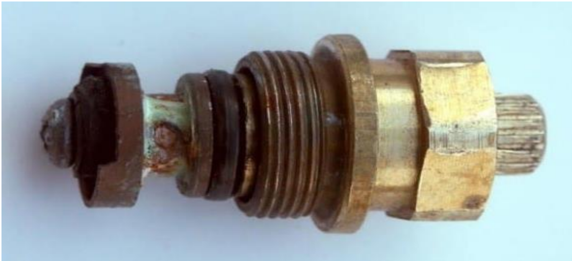
Şekil 1.6. Pirinç vanada olan seçici korozyon sonucunda çinkonun alaşımdan uzaklaşması (URL-5 2021)
