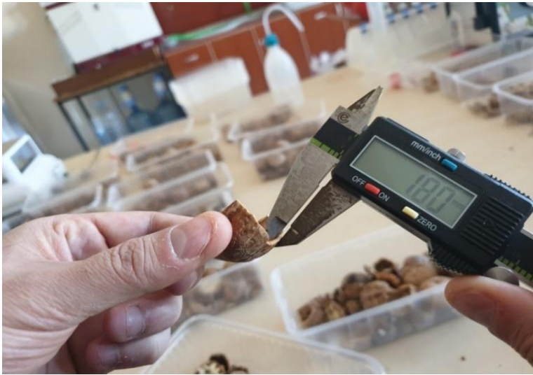
Şekil 3.9. Meyvelerin kabuk kalınlığının kumpas ile ölçülmesi
