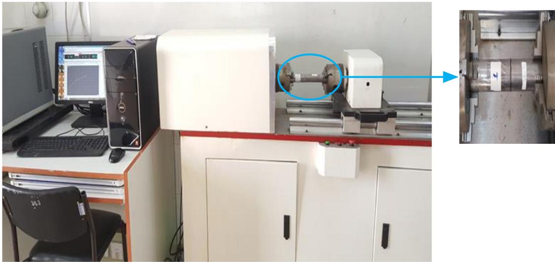
Şekil 3.18. JİNAN NDW-200 burulma test cihazı
