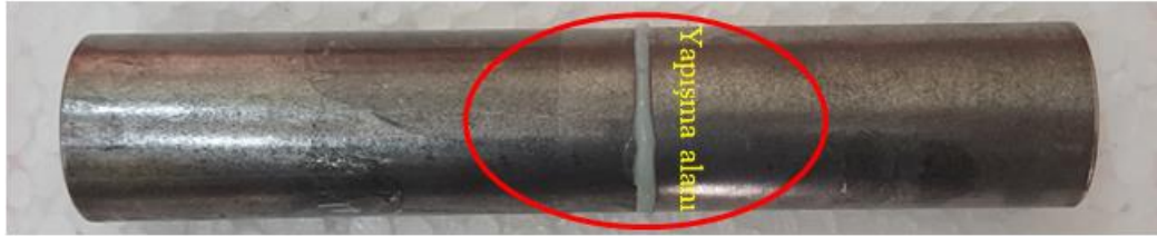
Şekil 3.8. Yapıştırıcıyla birleştirilmiş numune
