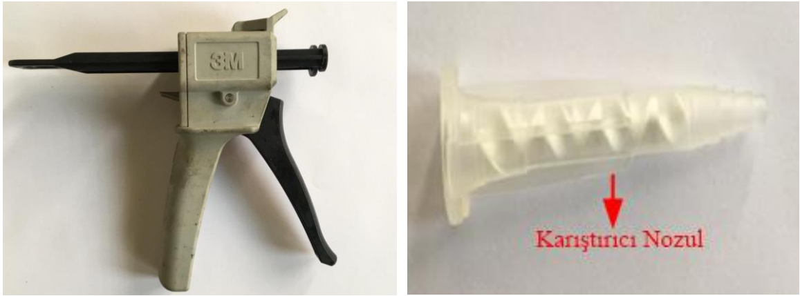
Şekil 3.15. Yapıştırıcı tüpleri sıkmak için kullanılan tabanca ve karıştırıcı nozul
