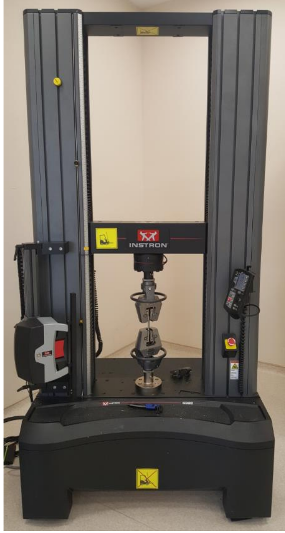
Şekil 3.10. Transmisyon mili mekanik özelliklerinin belirlendiği INSTRON çekme cihazı
