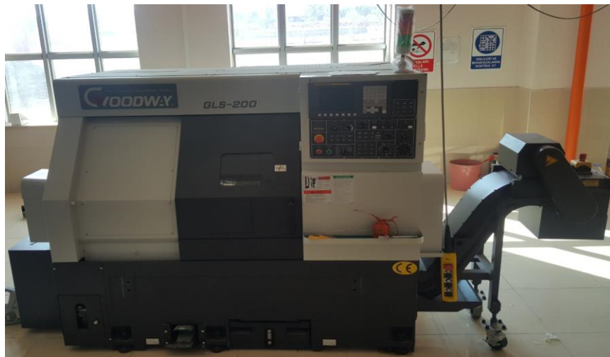
Şekil 3.7. Millerin işlendiği CNC torna tezgahı
