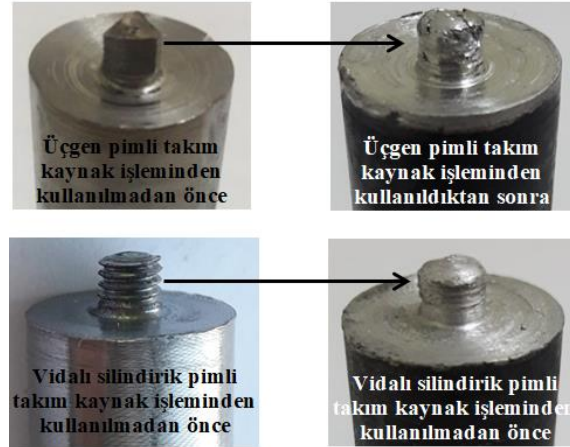
Şekil 4.43. SKNK işlemi sırasında üçgen ve vidalı silindirik pimli takımların pimine ve omuzuna yapışan malzeme
