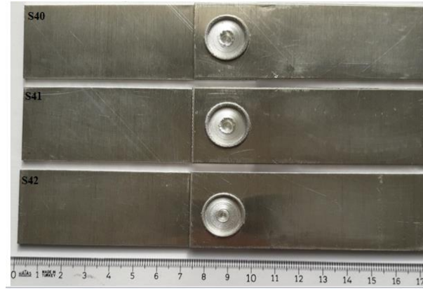
Şekil 3.11. 7075-T651 Al alaşımı plakaların üçgen pimli takım ile yapılan kaynaklar
