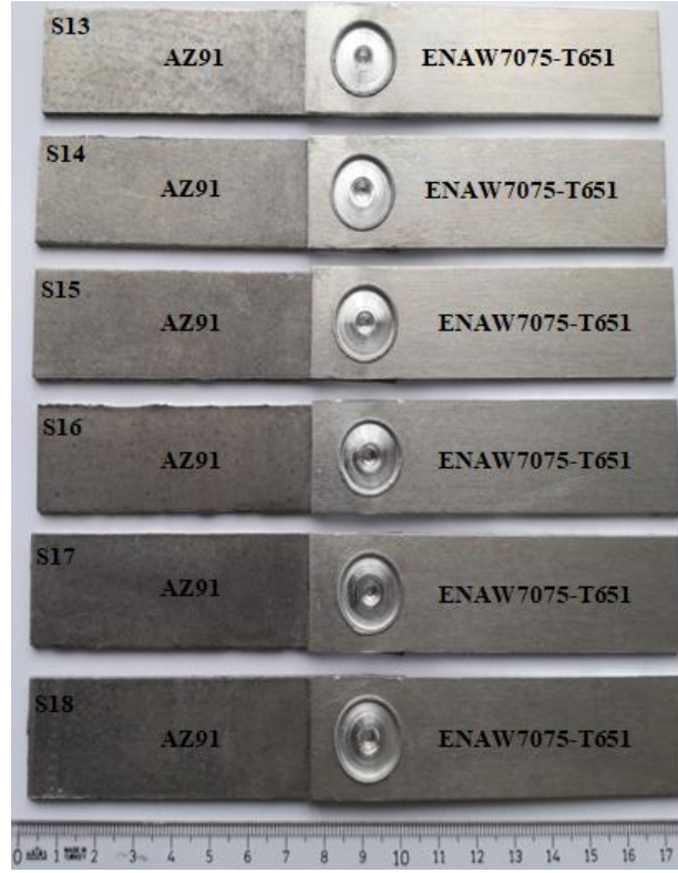
Şekil 3.6. 7075-T651 Al alaşımı plaka, AZ91 Mg alaşımı plakanın üstüneyken, üçgen pimli takım ile yapılan kaynaklar
