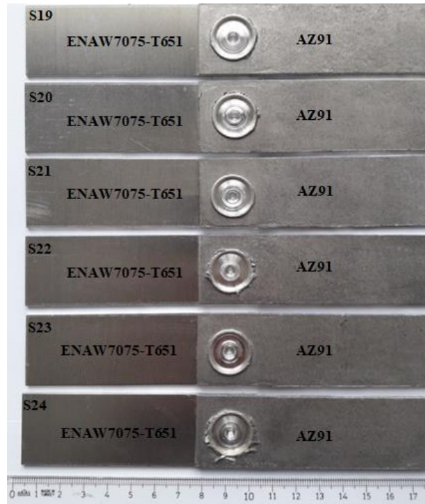
Şekil 3.7. AZ91 Mg alaşımı plaka, 7075-T651 Al alaşımı plakanın üstüneyken, üçgen pimli takımla yapılan kaynaklar
