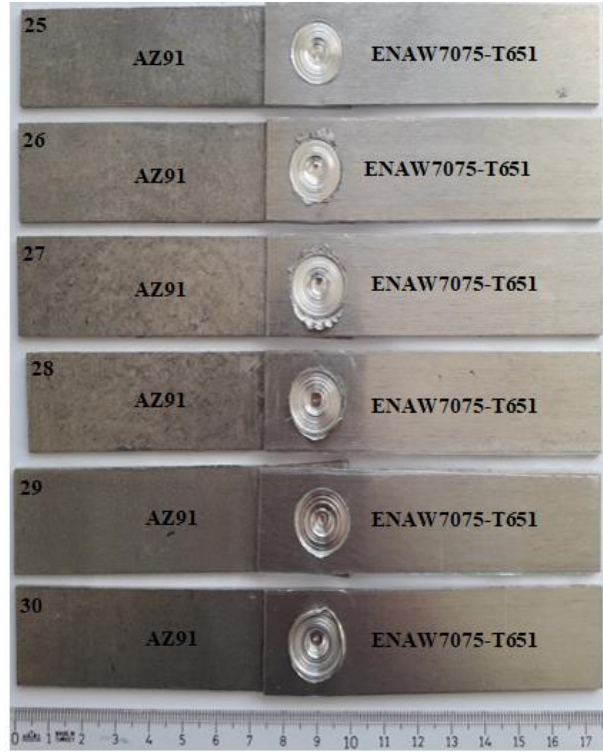
Şekil 3.8. 7075-T651 Al alaşımı plaka, AZ91 Mg alaşımı plakanın üstüneyken, vidalı silindirik pimli takım ile yapılan kaynaklar
