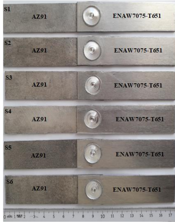
Şekil 3.4. 7075-T651 alaşımı plaka, AZ91 Mg alaşımı plakanın üstündeyken, konik pimli takım ile yapılan kaynaklar
