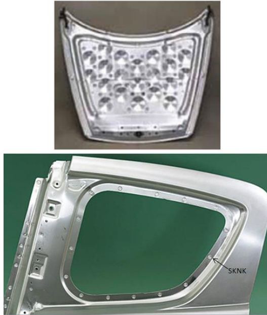
Şekil 2.8. Mazda tarafından SKNK ile üretilmiş alüminyum motor kaputu ve arka kapı ve kaynakların görünümü (Kaluç ve Taban 2007)
