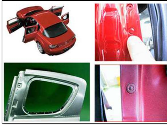
Şekil 2.7. SKNK kullanılarak imal edilmiş Mazda RX-8'in yan kapı paneli ve SKNK kaynaklarının görünüşü (Kaluç ve Taban 2007)
