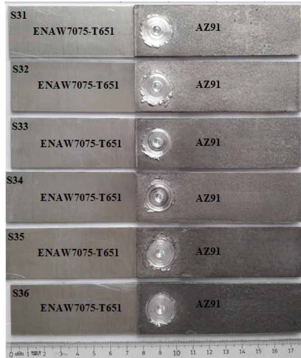
Şekil 3.9. AZ91 Mg alaşımı plaka, 7075-T651 Al alaşımı plakanın üstüneyken vidalı silindirik pimli takım ile yapılan kaynaklar
