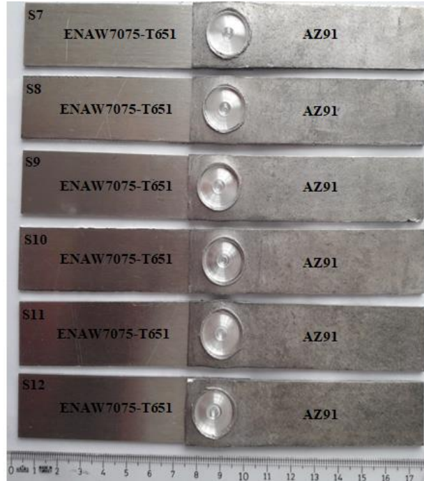
Şekil 3.5. AZ91 Mg alaşımı plaka 7075-T651 Al alaşımı plakanın üstündeyken, konik pimli takım ile yapılan kaynaklar
