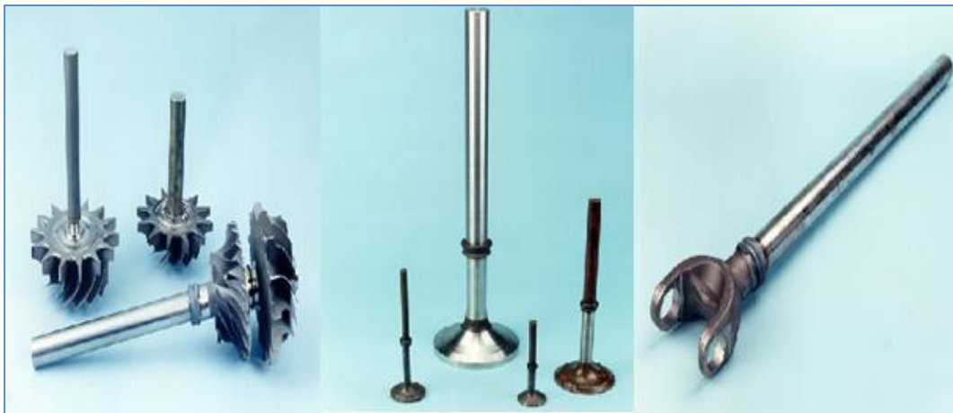
Şekil 2.6. Sürtünme kaynağı ile imal edilmiş parça (www.mtiwelding.com)
