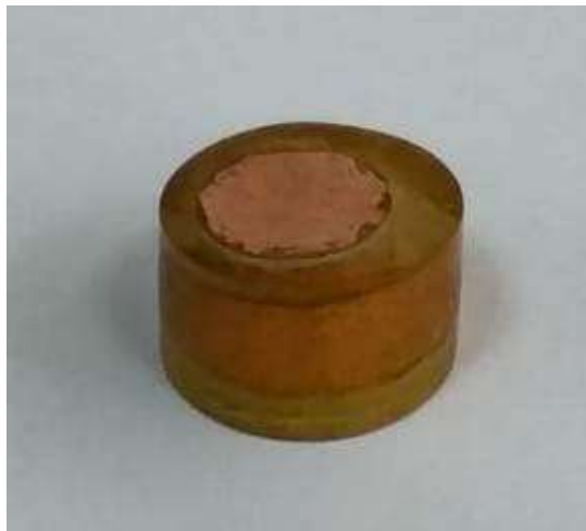
Şekil 3.2. 1cm çapındaki bakır elektrot
