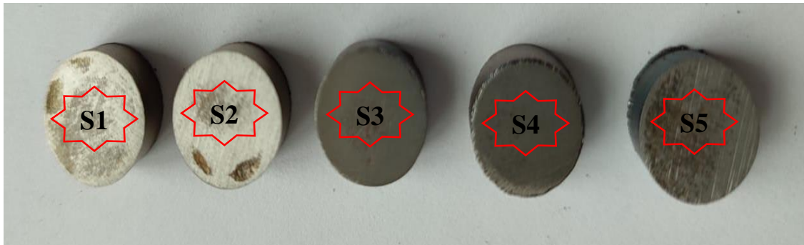
Şekil 4.1. Sinterlenmiş silindirik numuneler; S1;Ti1Mo6Ni, S2;Ti3Mo6Ni, S3;Ti5Mo6Ni, S4;Ti8Mo6Ni, S5;Ti10Mo6Ni
