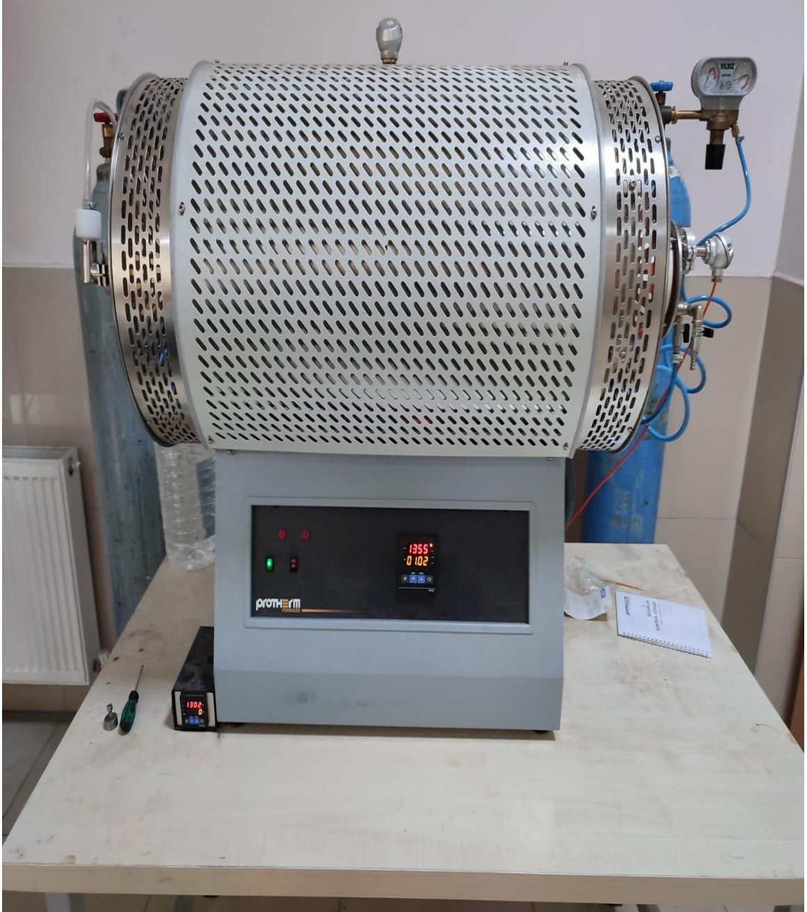
Şekil 3.7. Sinterleme işlemlerinin yapıldığı tüp fırın
