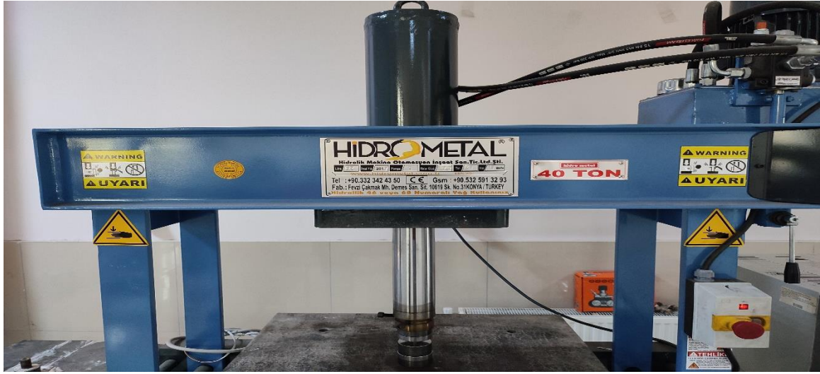
Şekil 3.5. Kalıplama işlemlerinin gerçekleştirildiği pres cihazı
