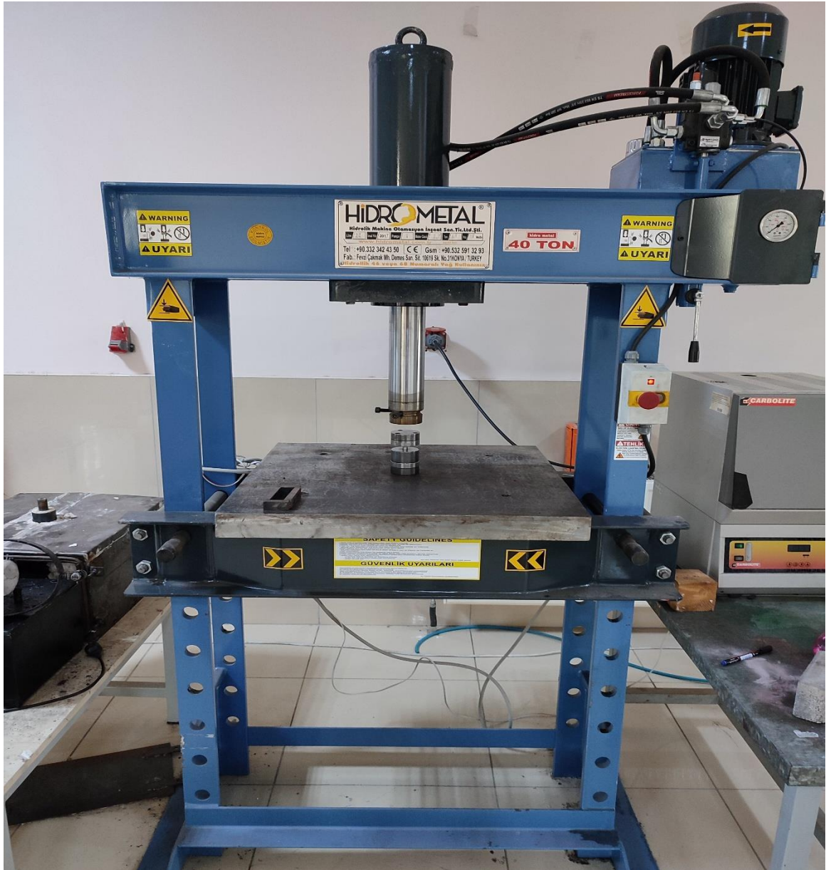
Şekil 3.2. Silindirik numuneler için presleme kalıbının resmi
