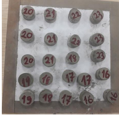
Şekil 3.5. Radyasyon zırlama ölçümleri için üretilen numunelerden örnek. (Herbir rakam bir numune kodunu temsil etmektedir).
