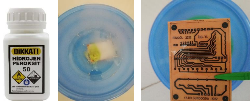
Şekil 3.34. Örnek perhidrol şişesi, hazırlanan çözelti ve çözelti sonrası devre
