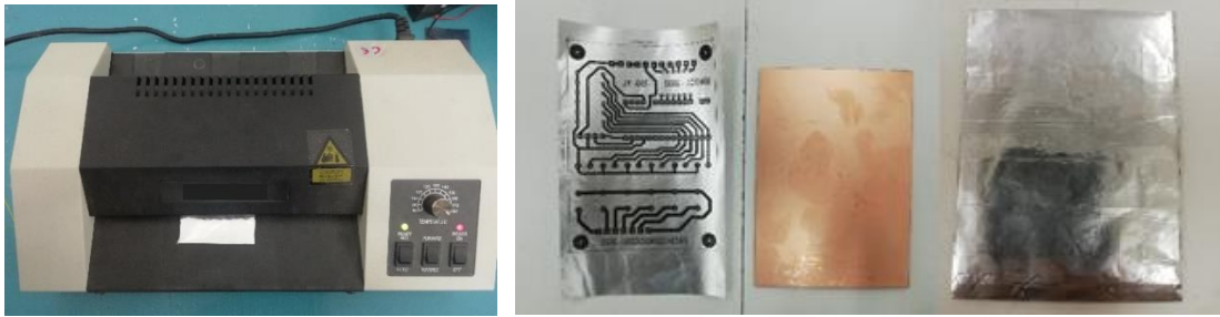
Şekil 3.32. Laminasyon cihazı ve plaket üzerine baskı devre şemasının preslenmesi
