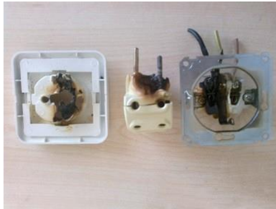
Şekil 1.14. Prizin ve fişin kömürleşmiş yol boyunca oluşan arklardan dolayı yanması (URL-21, 2022)
