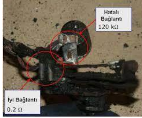
Şekil 1.13. Gevşek bağlantı yapılmış bir termostatta meydana gelen bozulma (Babrauskas, 2008)
