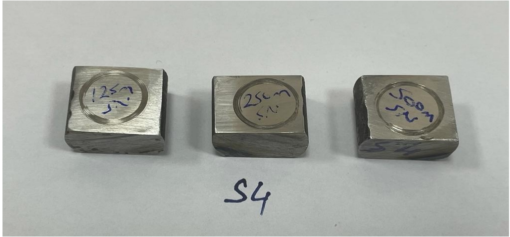
Şekil 3.31. S4 Aşınma numunesi (NiCrBAI-%5SiC)
