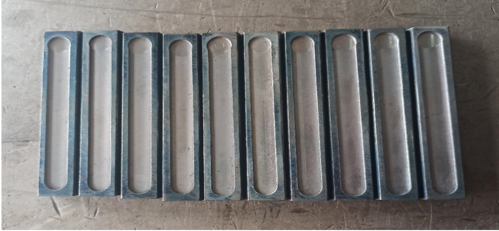
Şekil 3.10. Kanalı açılan çelik numuneler
