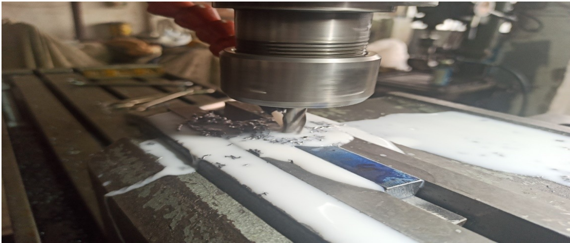
Şekil 3.9. Freze tezgahında çelik numuneye kanal açılma işlemi
