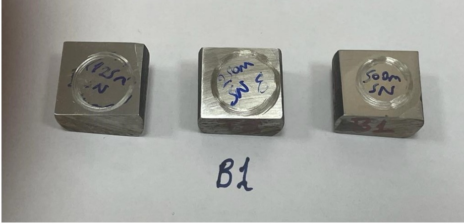
Şekil 3.33. B1 Aşınma numunesi (NiCrBAI-%1B 4 C)
