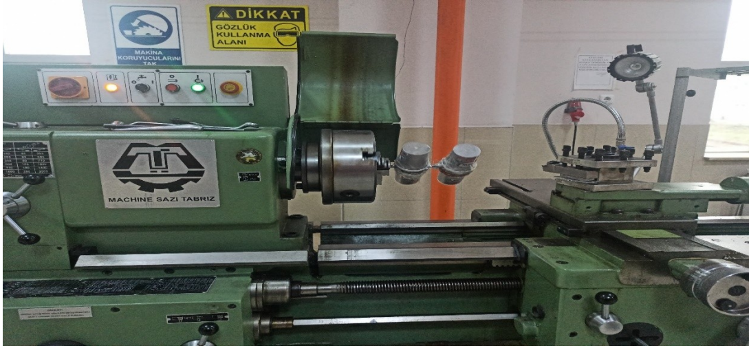
Şekil 3.8. Torna tezgahında karışımı sağlanan numune tozları
