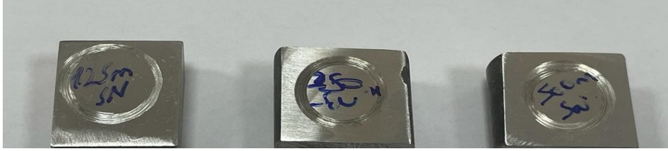
Şekil 3.36. B4 Aşınma numunesi (NiCrBAI-%7B4C)
