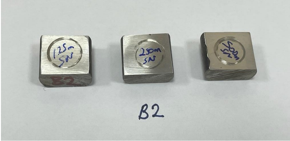
Şekil 3.34. B2 Aşınma numunesi (NiCrBAI-%3B 4 C)
