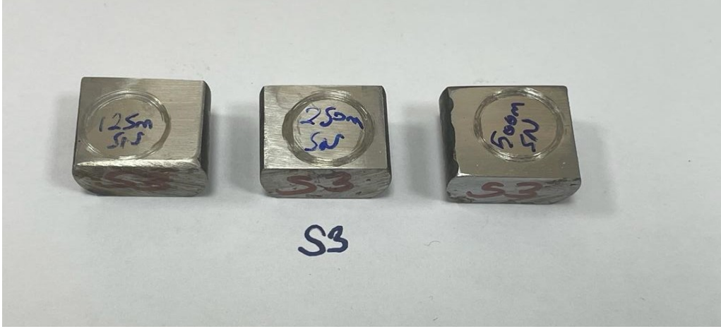
Şekil 3.30. S3 Aşınma numunesi (NiCrBAI-%3SiC)
