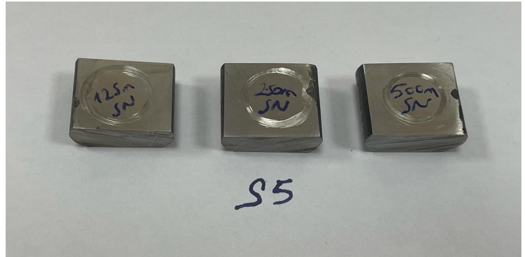
Şekil 3.32. S5 Aşınma numunesi (NiCrBAI-%7SiC)
