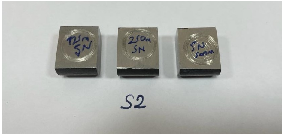
Şekil 3.29. S2 Aşınma numunesi (NiCrBAI-%1SiC)
