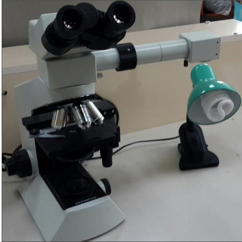
Şekil 2.12. Işık mikroskobuna monte edilmiş çizim aleti
