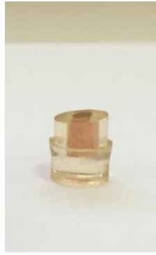
Şekil 2.2. Karakterizasyon ölçümlerinde kullanılan bakır numune (115M613 No'lu TÜBİTAK Projesi 2018)
