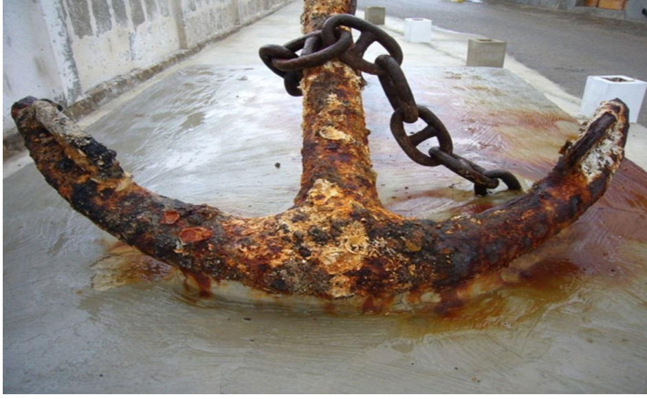
Şekil 1.8. Biyolojik korozyona uğramış gemi çapası (URL-6, 2019)
