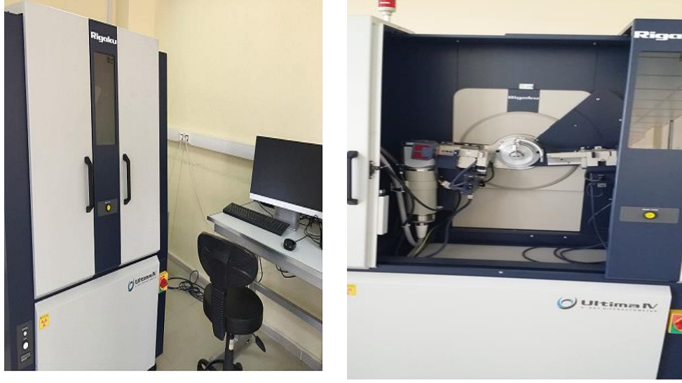
Şekil 3.6. XRD cihazı (X-ray diffraction)
