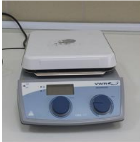
Şekil 3.3. Manyetik karıştırıcı (hot plate)
