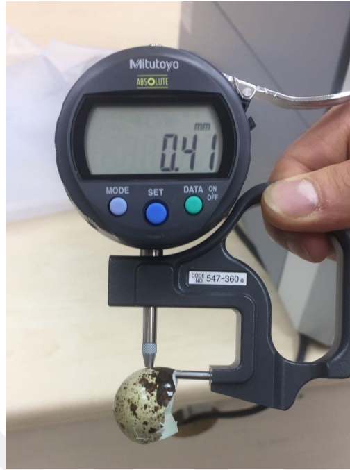
Şekil 3.8. Dijital mikrometre ile yumurta kabuk kalınlığının ölçümü
