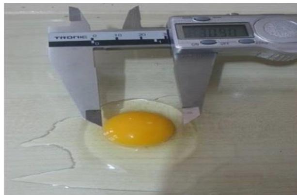
Şekil 3.7. Dijital kumpas kullanılarak yumurta ak ve sarı ölçümlerinin yapılması
