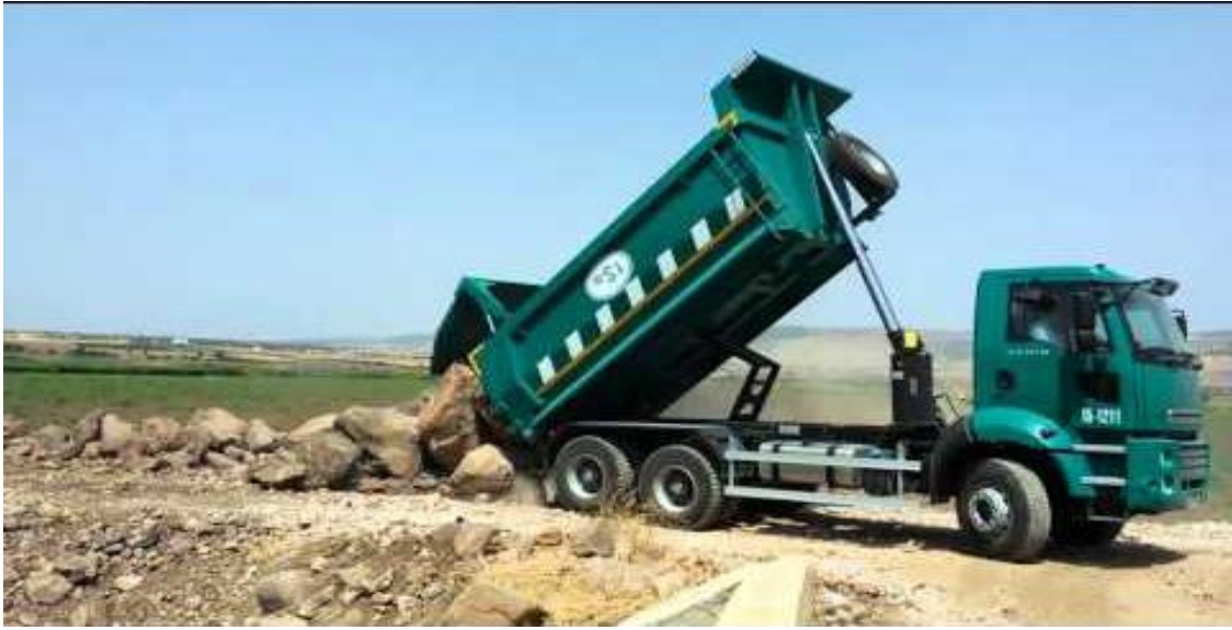
Şekil 4.2. Arkadan boşaltmalı kamyonlar ocaklarda yaygın kullanılan damper şekli
