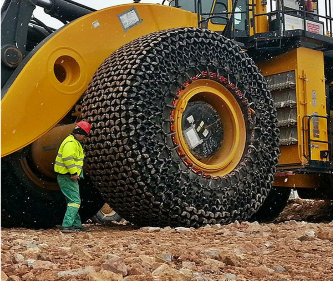
Şekil 2.13. Lastikli loderin lastiklerinin yırtılma ve aşınma karşı zincir takılması
