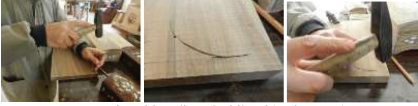
Fotoğraf 17. Piriç telin yerleştirilmesi (Bozkurt, 2014)
