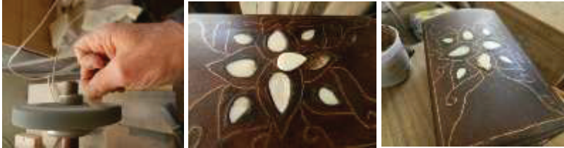
Fotoğraf 19. Midyenin şekillendirilmesi ve yerleştirilmesi (Bozkurt, 2014)
