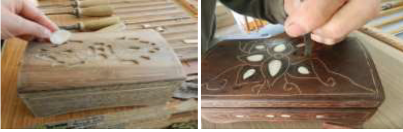
Fotoğraf 18. Sedef kakma işlemi için boşaltılmış desen örnekleri (Bozkurt, 2014)
