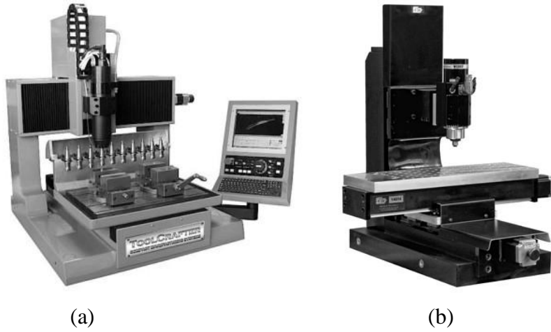
Şekil 2.13 Mikro freze tasarımları ( a) Köprü tipi CNC, (b) C tipi CNC (Tütünsatar 2010).
