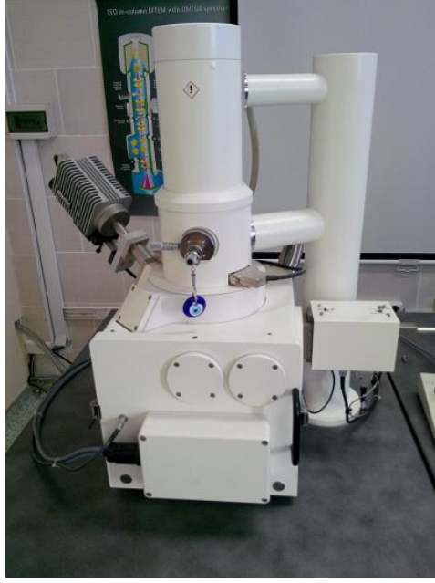
Şekil 3.6 Üretilen malzemelerin ve aşınan kesici takım yüzeylerinin görüntüsünün alındığı taramalı elektron mikroskobu.
