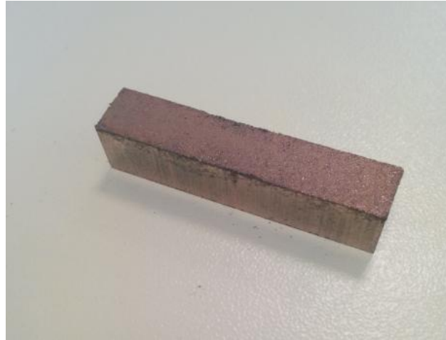
Şekil 3.2 Presleme sonrası numunenin fiziksel görünümü.
