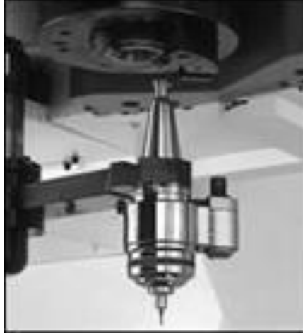
Şekil 2.15 Pnömatik destekli anahtarsız mandren tutuculu iş mili (Tütünsatar 2010).
