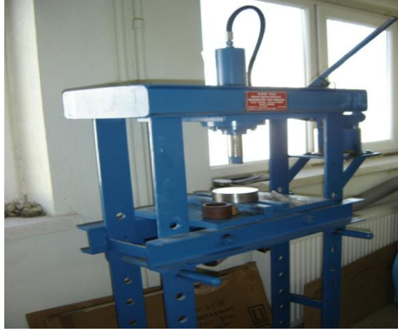
Şekil 3.3 W, Cu, Ag, Ni, Co tozlarının belirli kompozisyon yüzdelinde karıştırılarak kalıp içerisinde sıkıştırıldığı hidrolik pres.
