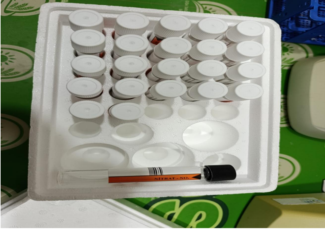
Şekil 3.18. Analizlerde kullanılacak Nitrat Tüptest 25 Kitleri
