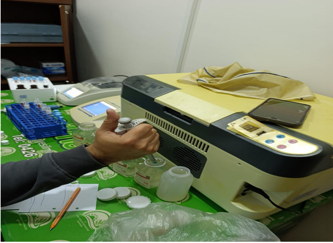
Şekil 3.20. Ayarlanabilir otomatik pipetle su numunesi kabından 0.7 ml suyun alınması
