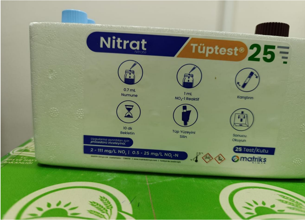
Şekil 3.19. Analizlerde kullanılacak Nitrat Tüptest 25 Kit Yöntemi
