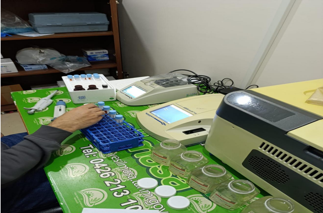
Şekil 3.23. Kimyasal işlemlerin bitirilip sonuç okunması için deney tüplerinin 10 dk bekletilmesi
