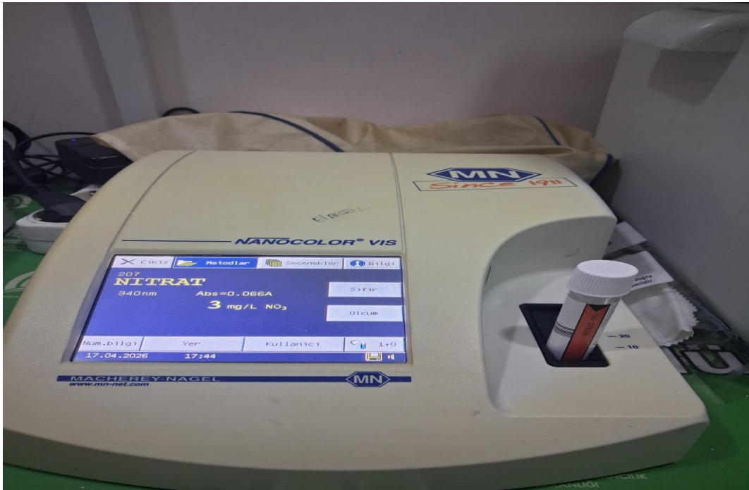
Şekil 3.25. Deney tüplerinin spektrometre cihazında Nitrat ölçümünün yapılması-2
