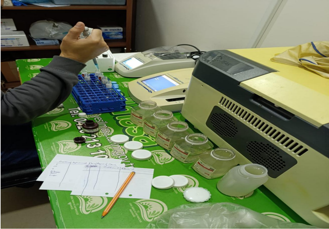
Şekil 3.21. Reaksiyon tüpüne 0.7 ml suyun eklenmesi
