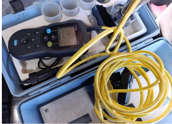
Şekil 3.26. Numune alma noktasında pH metre ile oksijen değeri, sıcaklık ve pH ölçümünün yapılması
