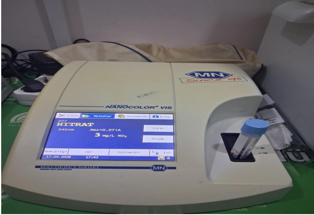
Şekil 3.24. Deney tüplerinin spektrometre cihazında Nitrat ölçümünün yapılması-1
