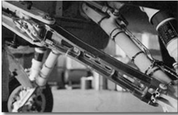
Şekil 2.2. Titanyum matrisli F-16 iniş takımları (Toptan 2006)
