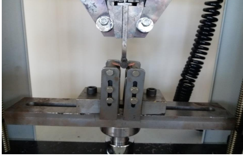
Şekil 4.3. Üretilen kompozitin eğilme deneyi makro fotoğrafı
