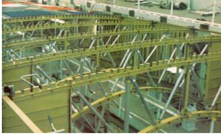
Şekil 2.1. Uzay mekiğinin gövdesinde kullanılan alüminyum tüpler (Toptan 2006)
