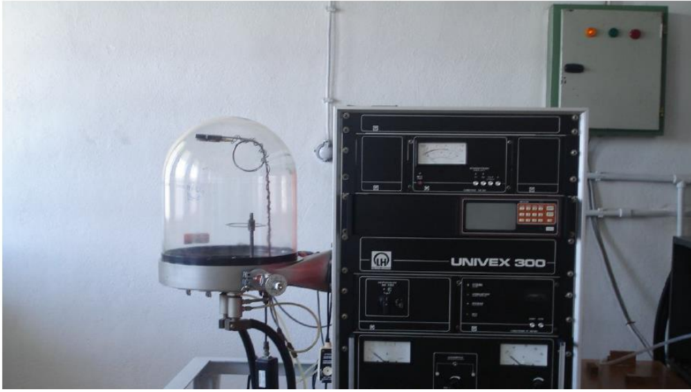
Şekil 3.1. Termal buharlaştırma ünitesi
