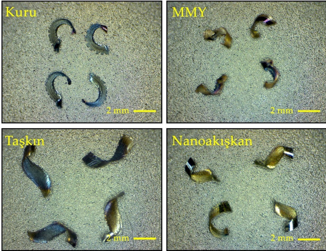
Şekil 4.19. 75 m/dk kesme hızı ve 0,100 mm/dev ilerleme hızı için farklı soğutma/yağlama ortamlarında elde edilen talaş morfolojileri
